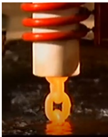
Figura 11 - Tratamento térmico por indução.
