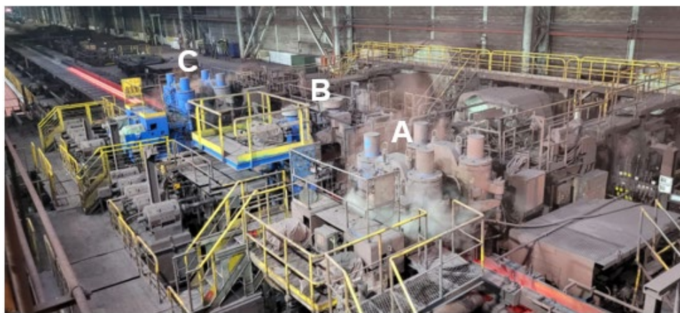
Figura 2 - Grupo de laminadores tandem - laminador desbastador (A); laminador acabador do flange (B); laminador acabador (C).
