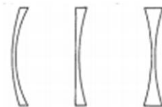
Figura 12 - Representação das lentes divergentes. Da esquerda para a direita :convexo côncava, plano côncava e bicôncava
