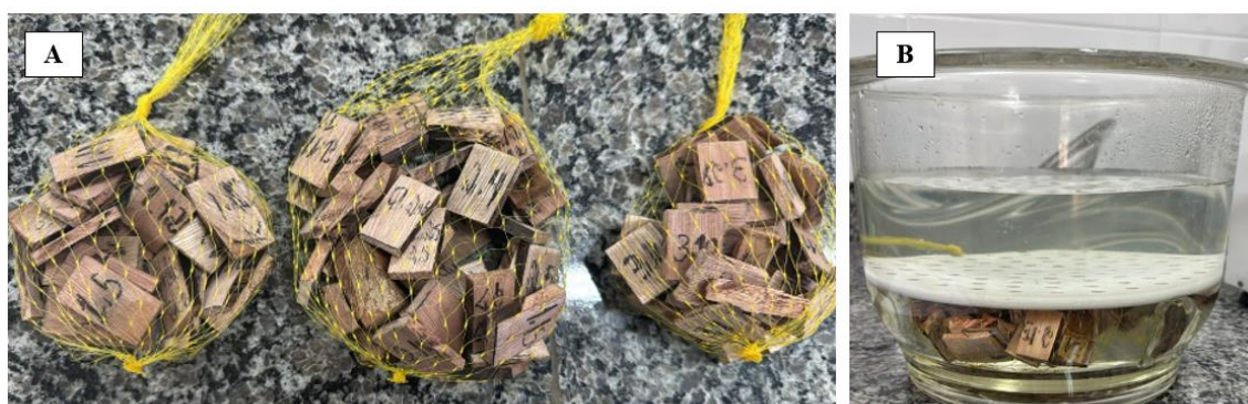
Figura 4 – Procedimento de saturação das amostras em dessecador acoplado a bomba de vácuo. Onde A = Amostras separadas por árvore para serem levadas ao dessecador e B = Amostras em dessecador conectado à bomba de vácuo para saturação das amostras
