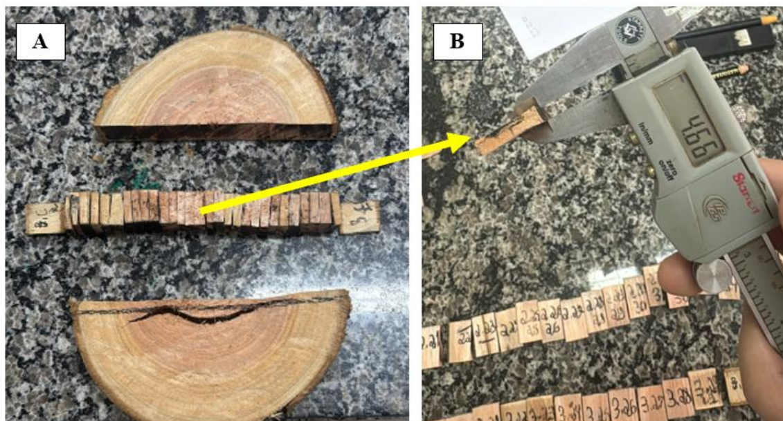
Figura 3 – Determinação das espessuras de cada amostra para posterior ponderação da densidade básica e análise gráfica. Onde A = Amostras representativas de toda a seção radial e B = Determinação das espessuras das amostras com paquímetro
