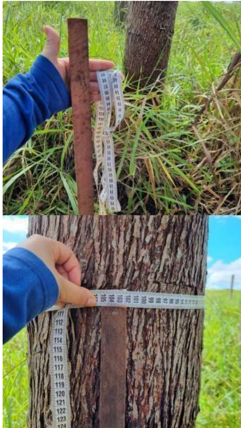
Figura 3 - Materiais utilizados e mensuração do diâmetro a altura de peito (DAP).
