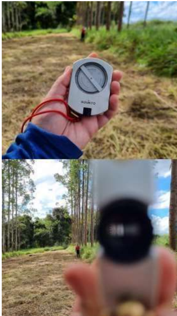
Figura 4 – Uso do clinômetro Suunto para mensuração da altura.
