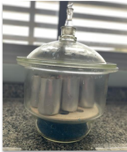
Figura 5 - Acondicionamento em ambiente dessecador para resfriamento térmico.
