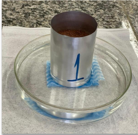
Figura 3 - Saturação das amostras de solo por capilaridade.
