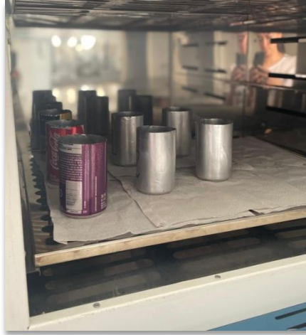
Figura 4 - Processo de secagem controlada das amostras de solo em estufa.
