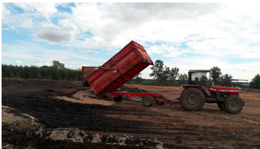
Figura 4.16 – Operação de montagem das leiras de compostagem
