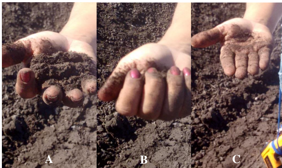
Figura 4.25 – Teste da mão para verificação de umidade e maturação do composto
