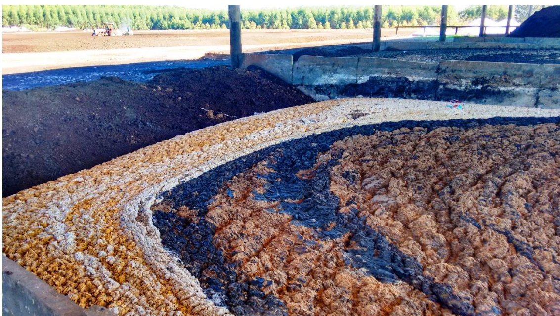
Figura 4.14 – Baía de armazenamento de lodo de indústrias de alimentos (LBM + LL)
