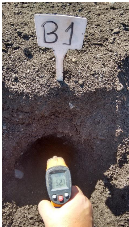
Figura 4.24 – Medição da temperatura na parte central da leira
