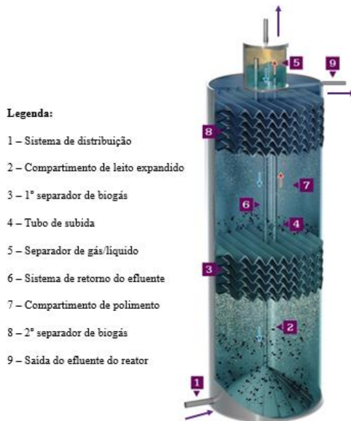
Figura 3.6 – Reator anaeróbio de circulação interna
