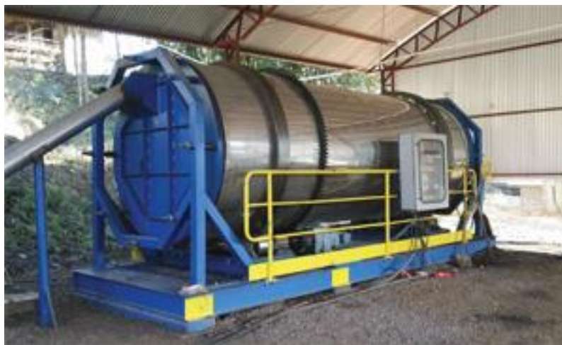
Figura 3.15 – Reator biológico para compostagem acelerada
