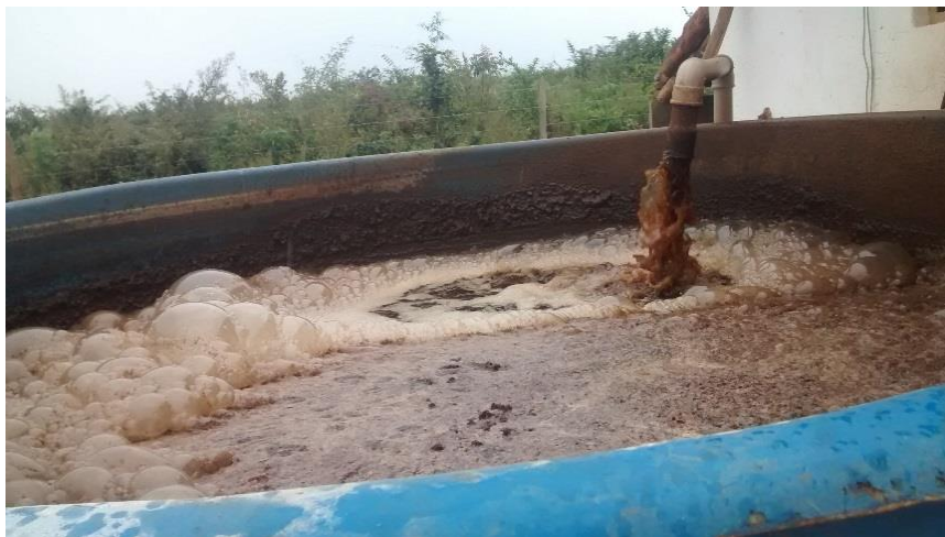
Figura 4.7 – Reator aeróbio com o inóculo de microrganismos pronto para utilização na compostagem
