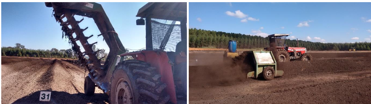
Figuras 4.20 e 4.21 – Operação de revolvimento mecânico das leiras de compostagem
