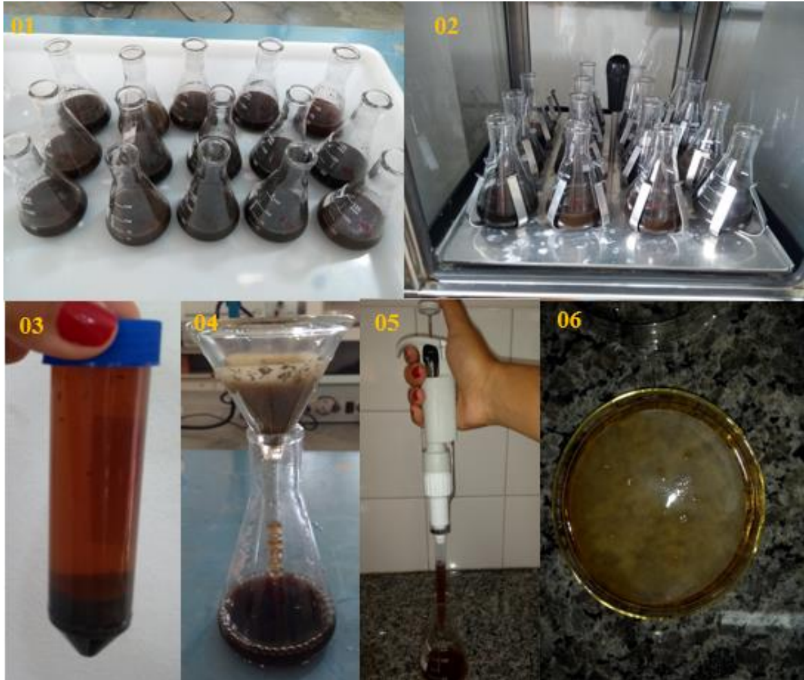
Figura 4.28 – Resumo da execução do teste de germinação
