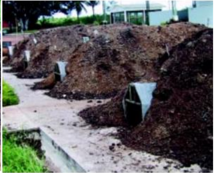
Figura 3.13 – Sistemas de leiras estáticas aeradas através de ventilação natural
