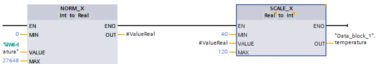
Figura 13 – Programação do CLP: leitura de um sensor de temperatura
