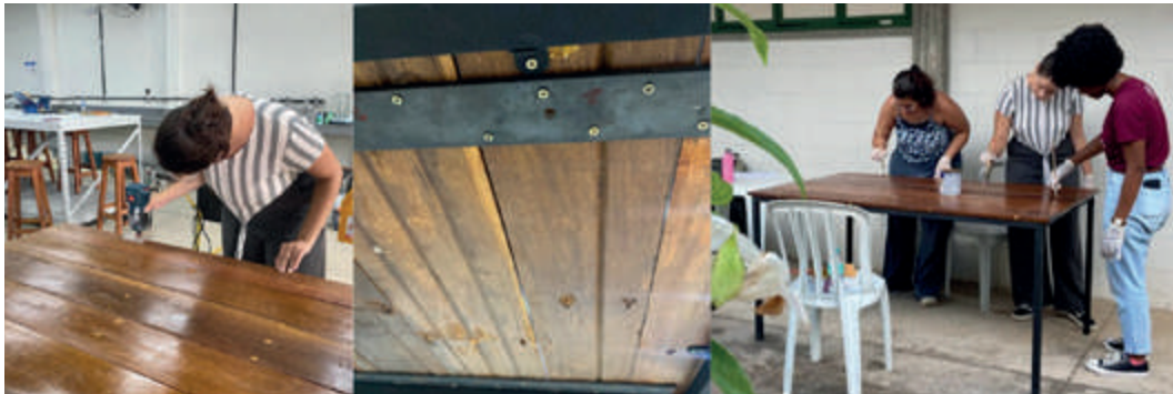
Figuras 7, 8 e 9 - Furação, fixação e lixamento das tábuas
