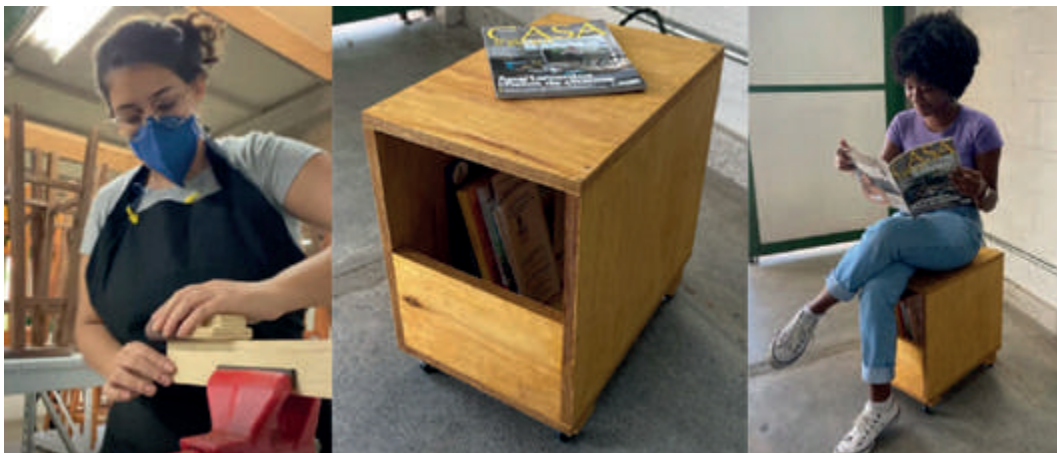
Figuras 4,5 e 6 - Lixamento manual, limpeza, envernizamento e produto finalizado em uso
