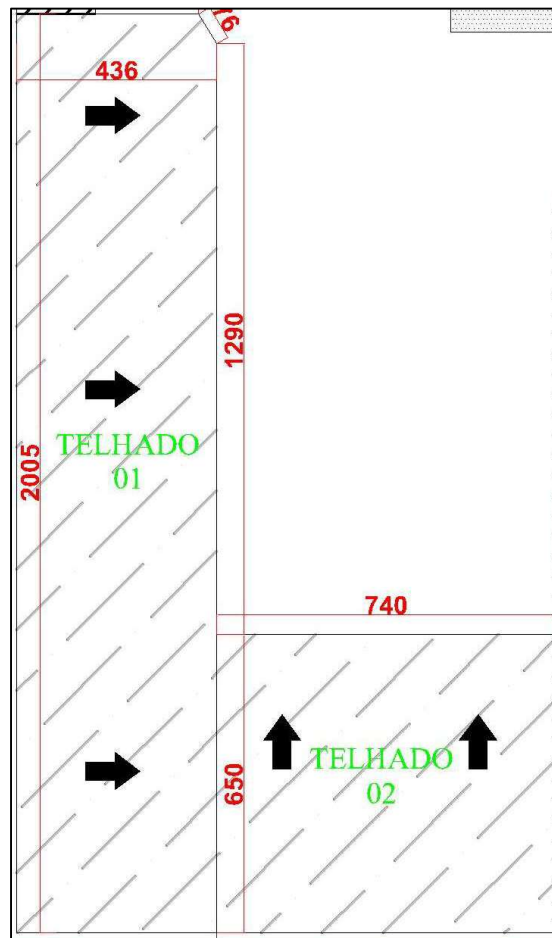
Figura 8 - Telhado ou cobertura de captação de água pluvial
