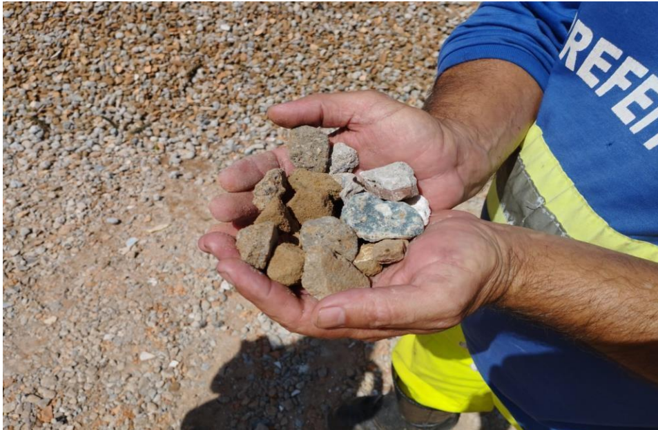
Figura 06 – Demonstração de granulometria da usina – Brita 2
