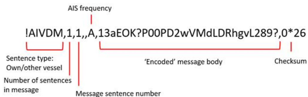
Figura 5 – Estrutura de uma sentença AIS no formato NMEA (AIVDM).
