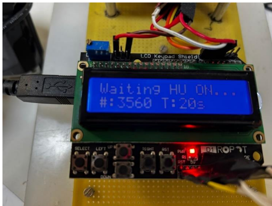
Figura 29: Estado final do teste contínuo após 3.560 ciclos sem falhas.
