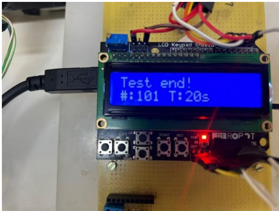
Figura 33: Display LCD indicando conclusão de 101 ciclos sem ocorrência da falha tela preta.
