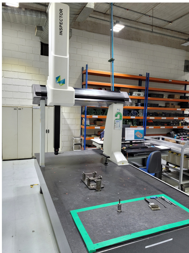
Figura 6 – máquina de medição por coordenadas(MMC) modelo Hexagon Global Performance 09.15.08 2013.
