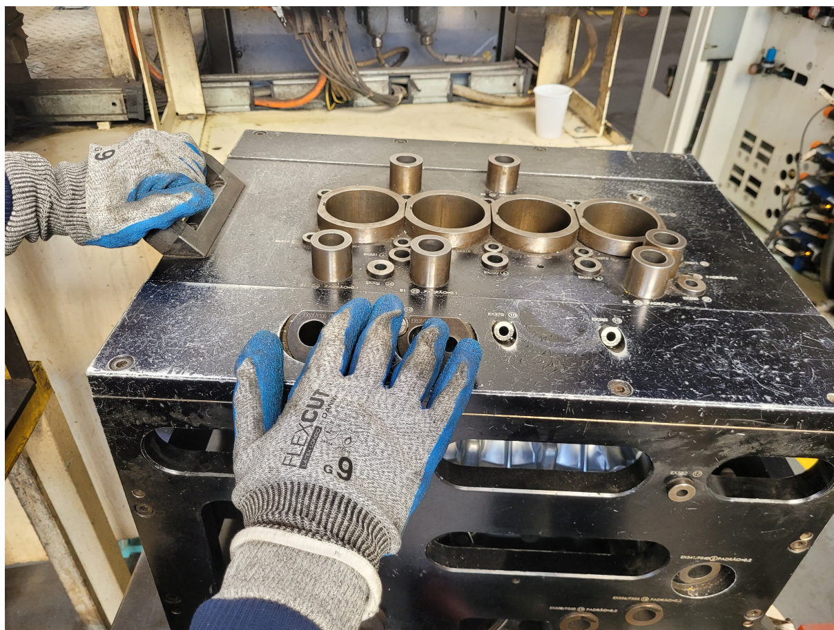
Figura 12 – Fechamento da máscara para controle manual.
