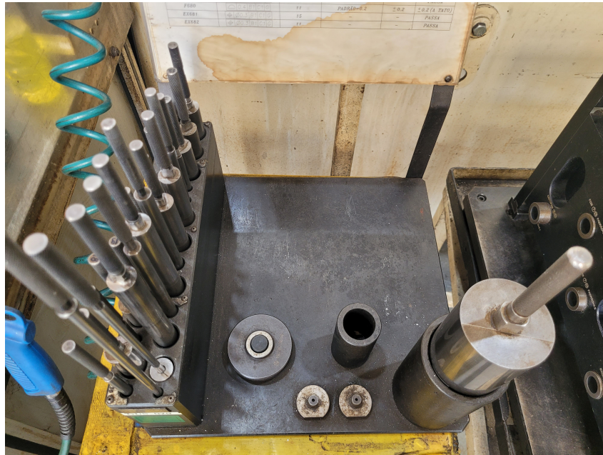
Figura 5 – Tampões "passa/não passa" da máscara de controle de deslocamento de usinagem Bloco Turbo.
