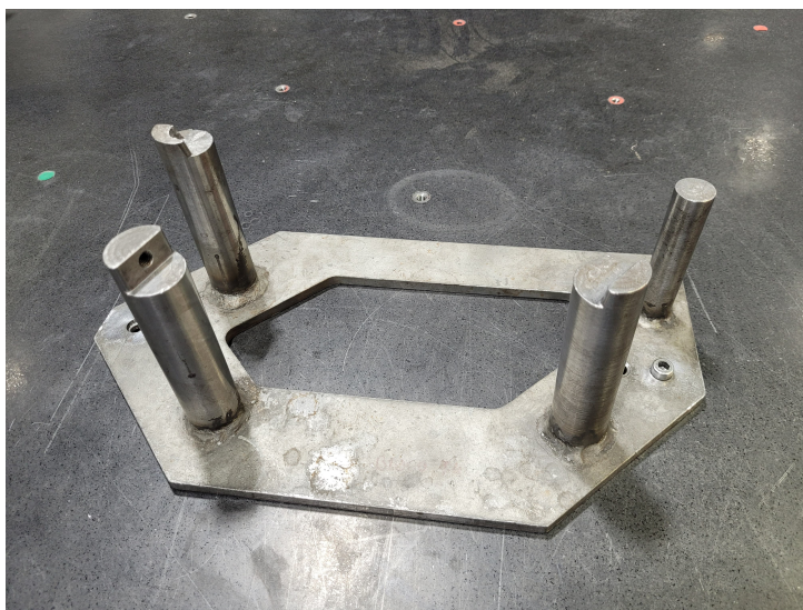
Figura 8 – Berço de apoio do bloco turbo.
