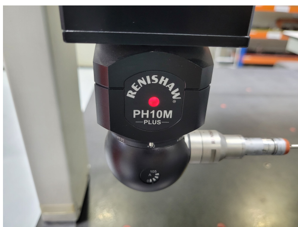
Figura 7 – cabeça de sonda de indexação motorizada modelo PH10M PLUS.
