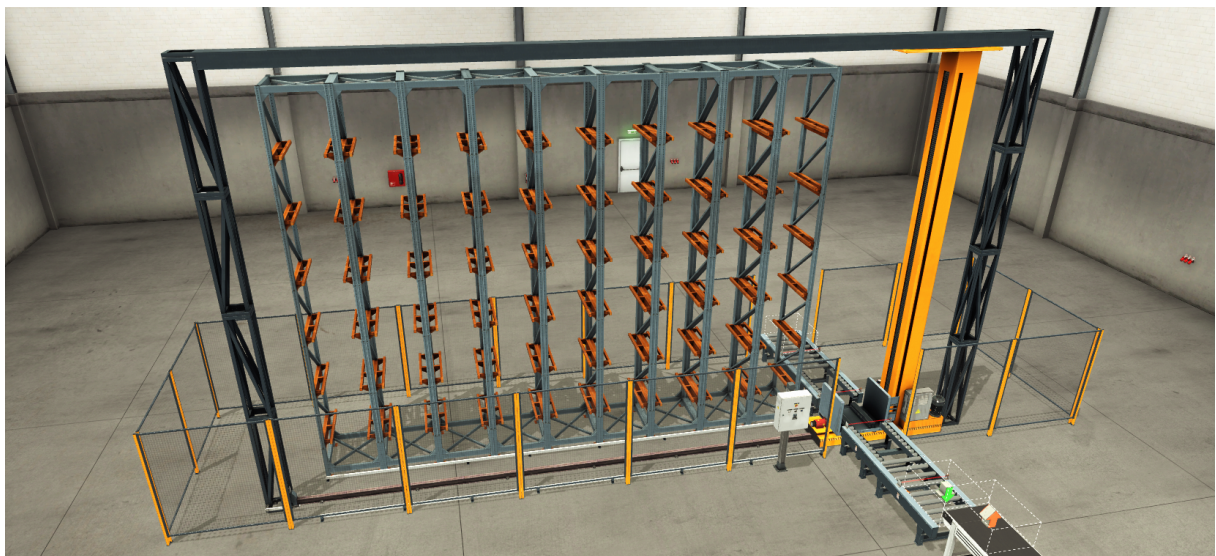
Figura 33 – Sistema de armazenamento automatizado com transelevador simulado no Factory I/O.
