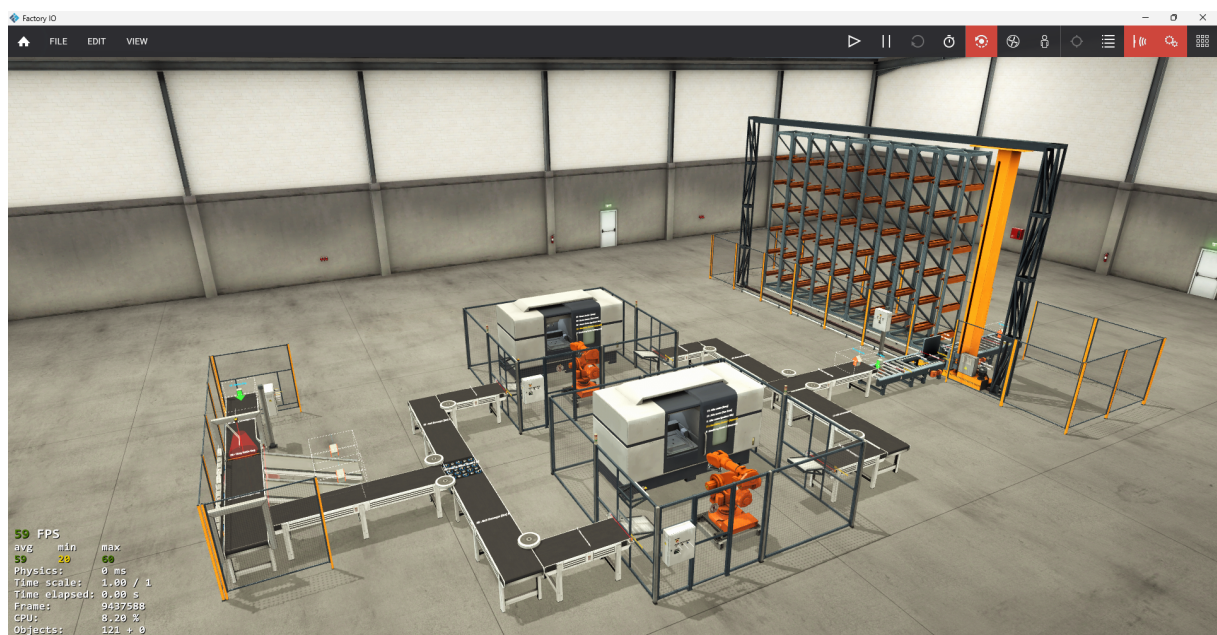
Figura 27 – Visão geral da planta no Factory I/O — ambiente de simulação.
