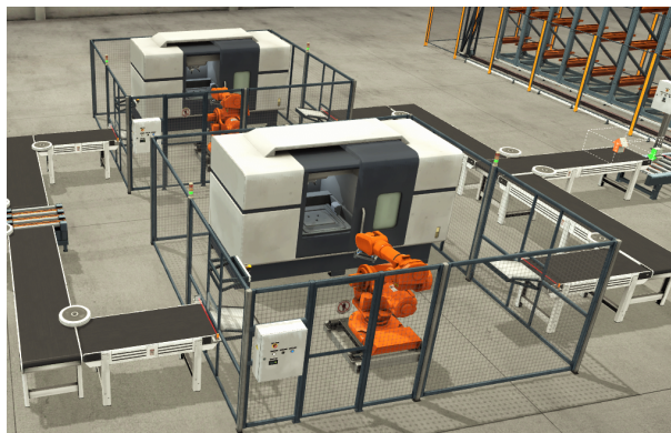
Figura 32 – Centro de usinagem com robôs industriais simulado no Factory I/O.
