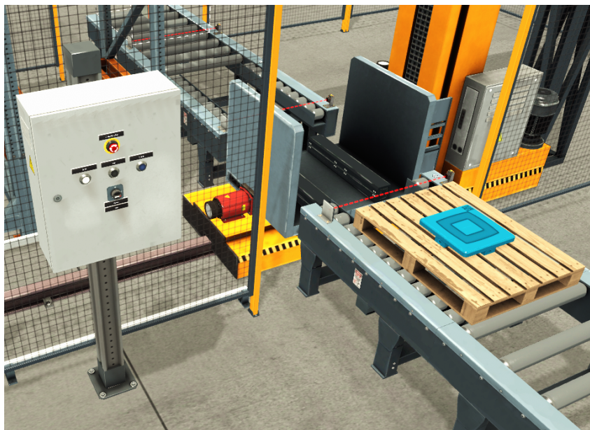
Figura 34 – Palete posicionado para coleta do carro tranferencia no Factory I/O.
