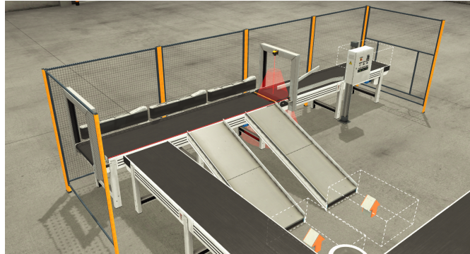
Figura 31 – Sistema automatizado de separação de matéria-prima no Factory I/O.
