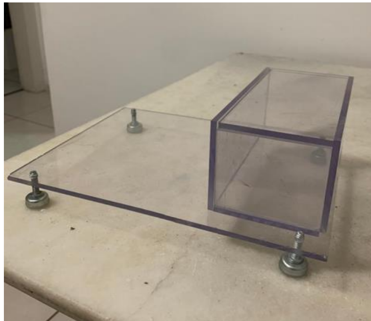
Figura 15: Fixação da caixa sobre a base.
