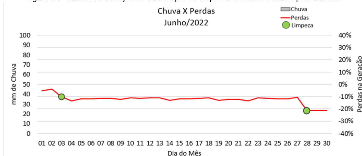
Figura 24 - Influência da sujeira em relação as limpezas manuais e índice pluviométrico
