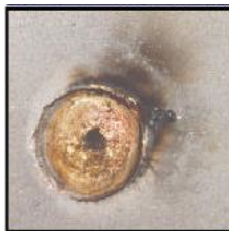
Figura 14: Defeito de latão e orifício na superfície
