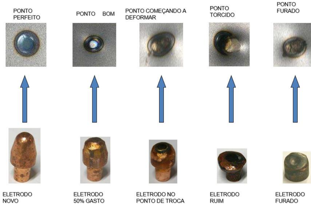
Figura 8: Efeito dos eletrodos durante a soldagem
