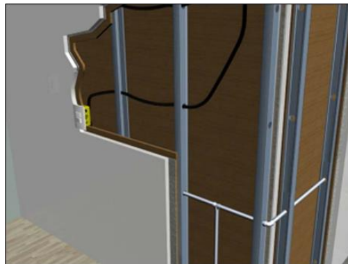
Figura 13: Embutimento de instalações no drywall
