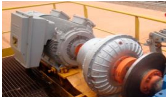
Figura 17 – Acoplamento hidrodinâmico ligado ao motor
