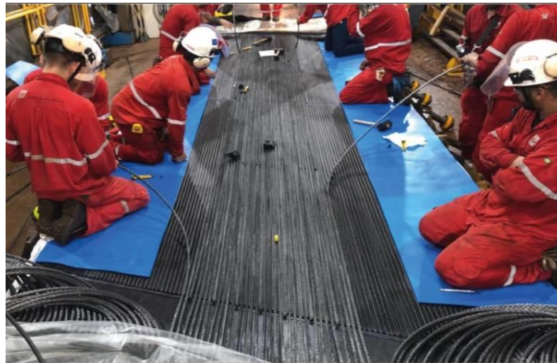
Figura 22 – Montagem de uma emenda Flexsteel
