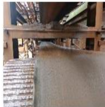
Pior Trecho Entre a 5ª e 6ª Emendas, provocou a quebra do Rolete Vertical de Alinhamento.
