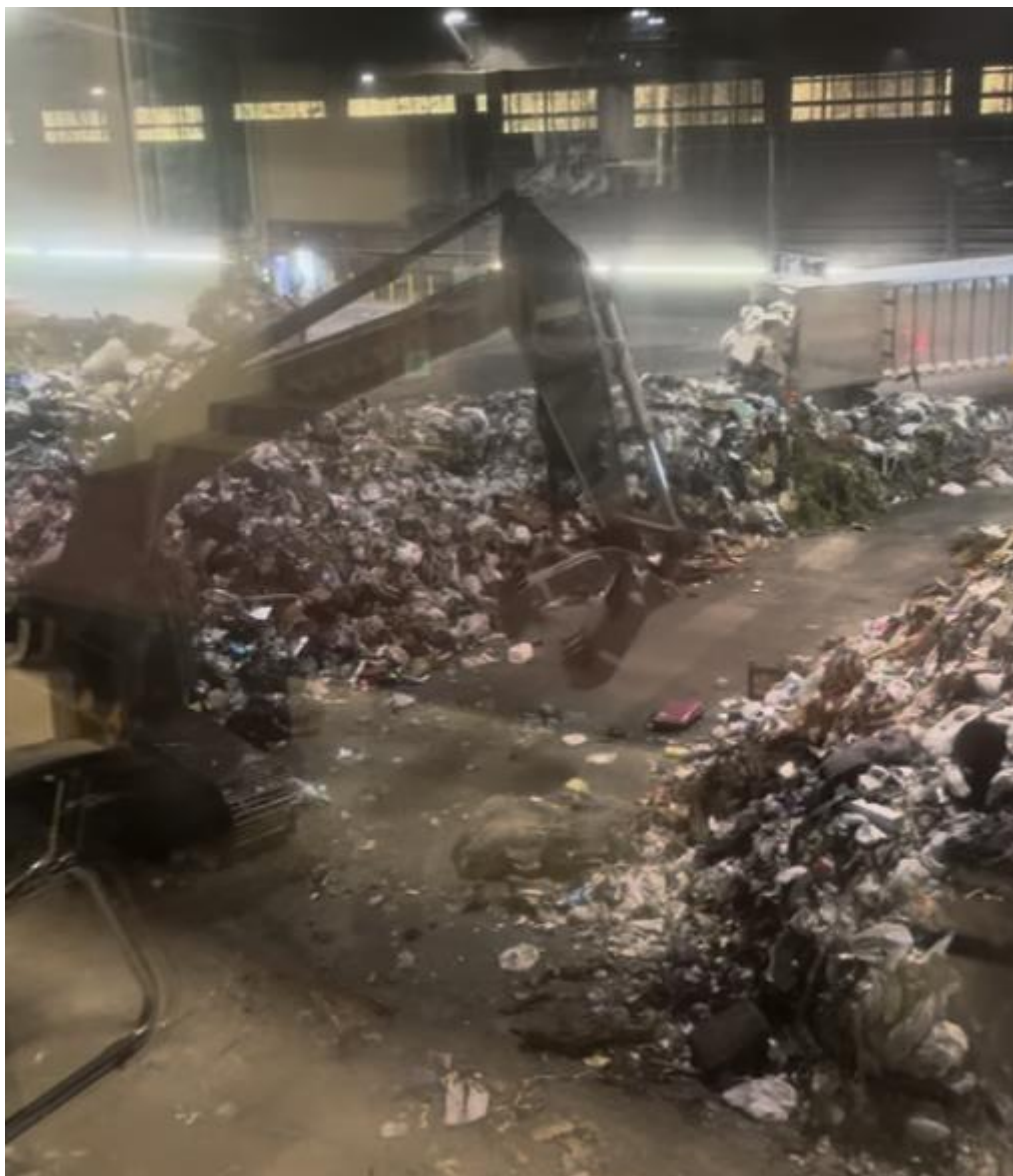
Figura 7 - Separação seletiva de resíduos de grande porte
