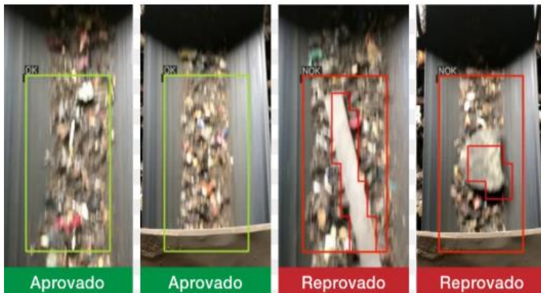
Figura 5 - Inspeção de corpos estranhos em esteira
