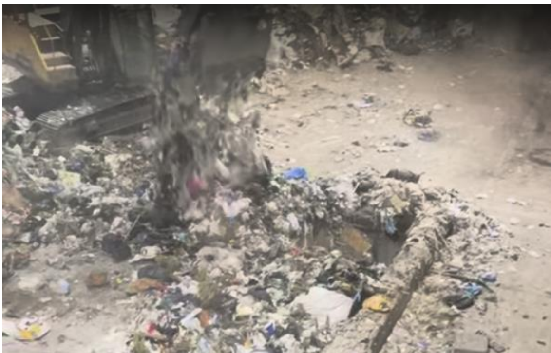
Figura 8 - Revolvimento da massa de resíduos
