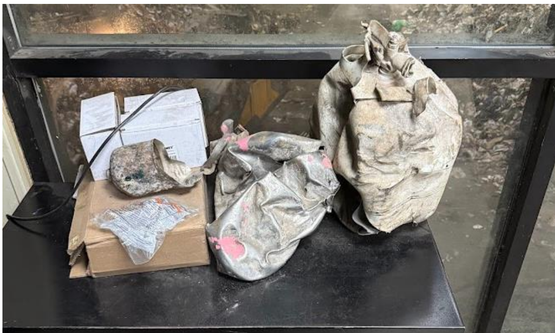
Figura 11 - Botijões de gás após atingirem a zona de trituração na planta
