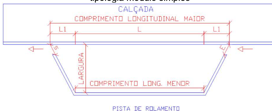
Figura 5.7 – Ilustração do modo de coletar as medidas do jardim de chuva de tipologia módulo simples
