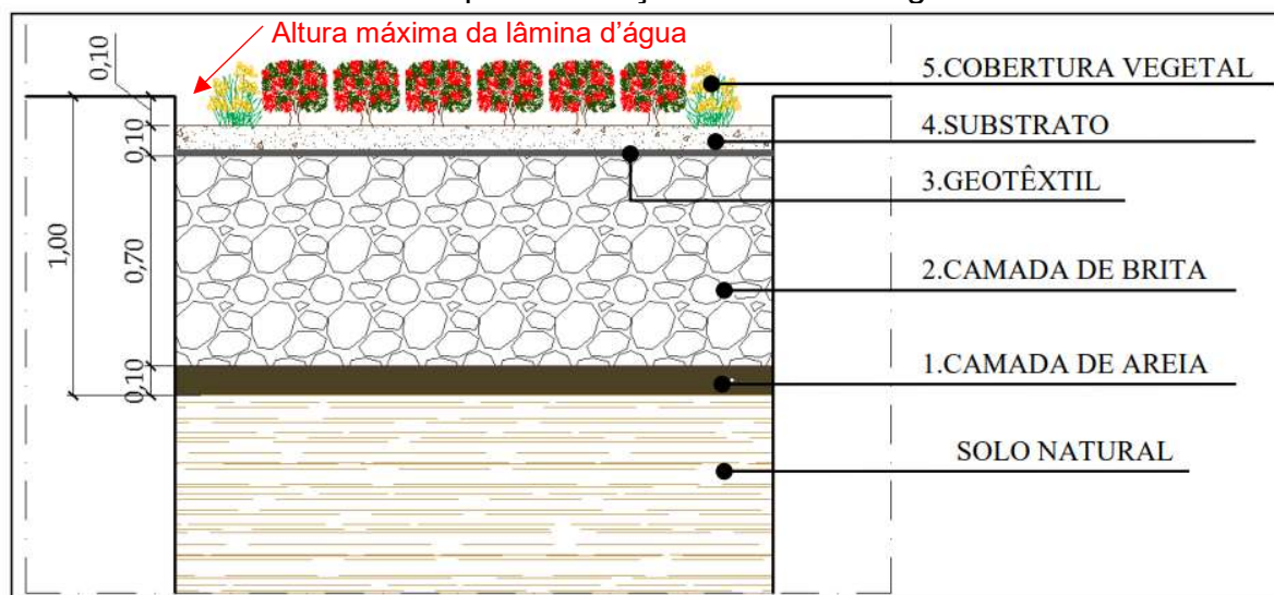
Figura 6.20 – Ilustração em corte de um jardim de chuva com à altura máxima definida para formação de lâmina d'água
