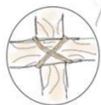
Sistema construtivo da parede de pau-a-pique, com adaptação da autora. (Fábio de Vasconcellos, 1979)
