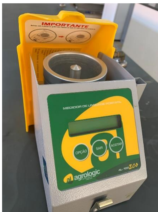
Figura 13 – Determinador de umidade digital utilizado para recebimento de grãos
