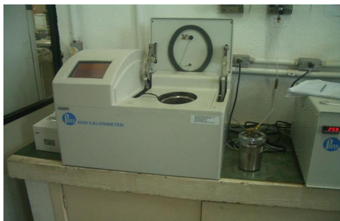
Figura 35 – Bomba calorimétrica mantida em laboratório de pesquisa
