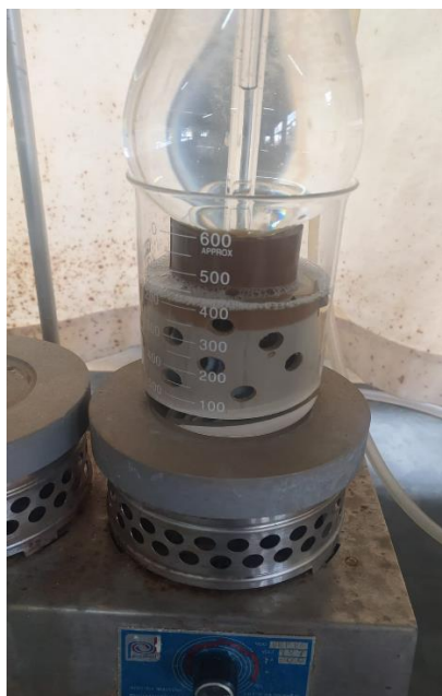
Figura 27 – Dispositivo alternativo montado em equipamento digestor de fibra
