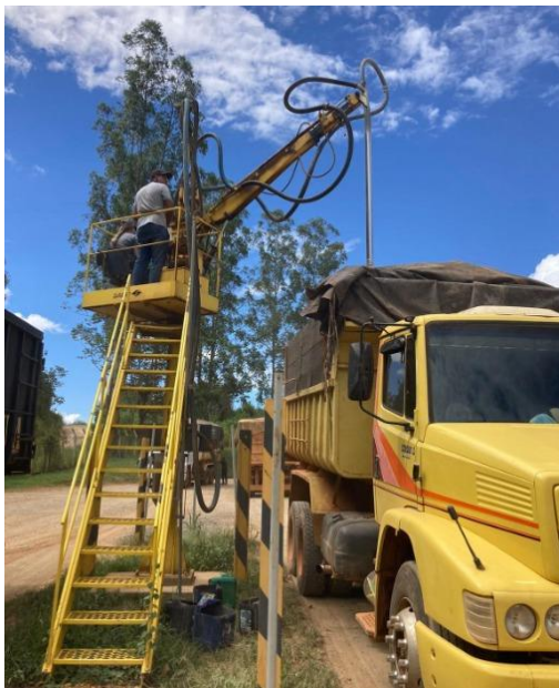
Figura 3 - Amostragem em caminhão de milho por sonda pneumática Cortesia SILO IJS
