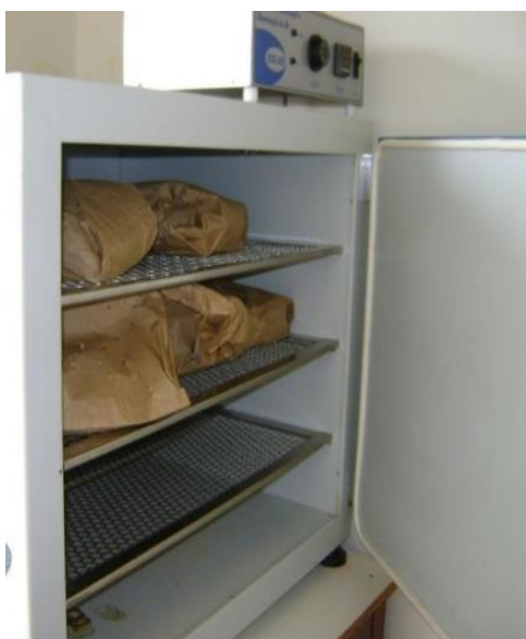
Figura 08 – Estufa com circulação de ar forçada utilizada para pré-secagem de amostras
