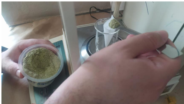
Figura 26 – Pesagem de amostra de forragem diretamente no saquinho de TNT
