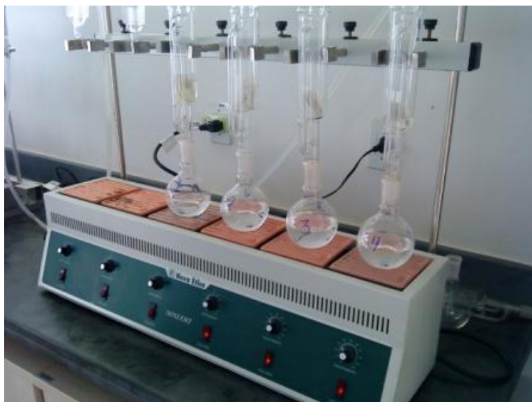
Figura 15 – Aparelho extrator de lipídeos do tipo Soxlet
