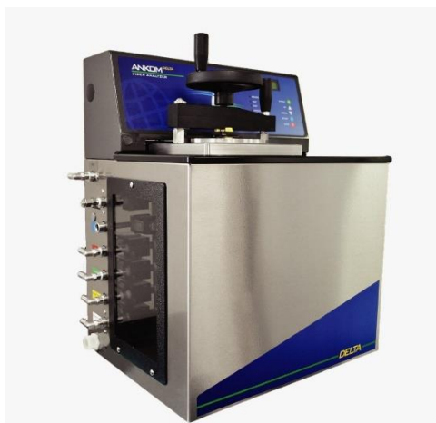
Figura 22 – Moderno equipamento utilizado para análise de FDN, FDA e fibra bruta
