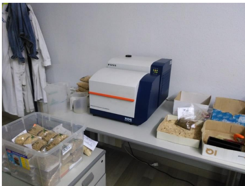
Figura 34 – NIRS de bancada em fábrica de ração de médio porte
