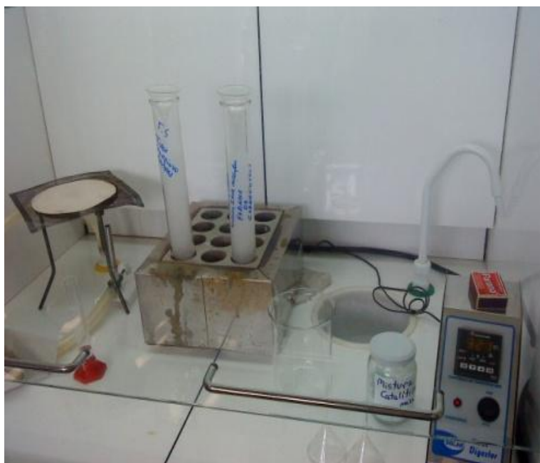
Figura 17 - Amostra sendo aberta a partir da utilização de bloco digestor. Esta operação deverá ser realizada dentro da capela de exaustão de gases.
