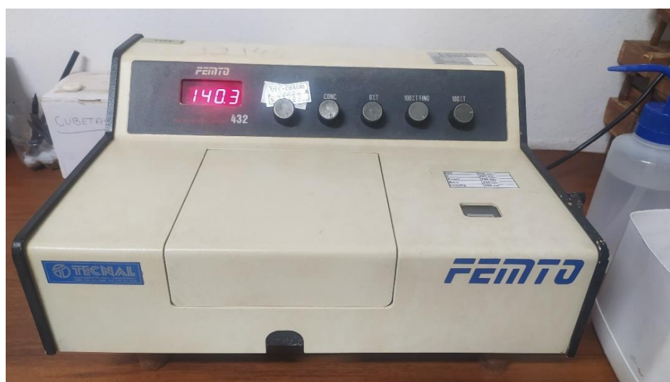
Figura 29 – Espectrofotômetro de bancada utilizado para análise de fósforo
