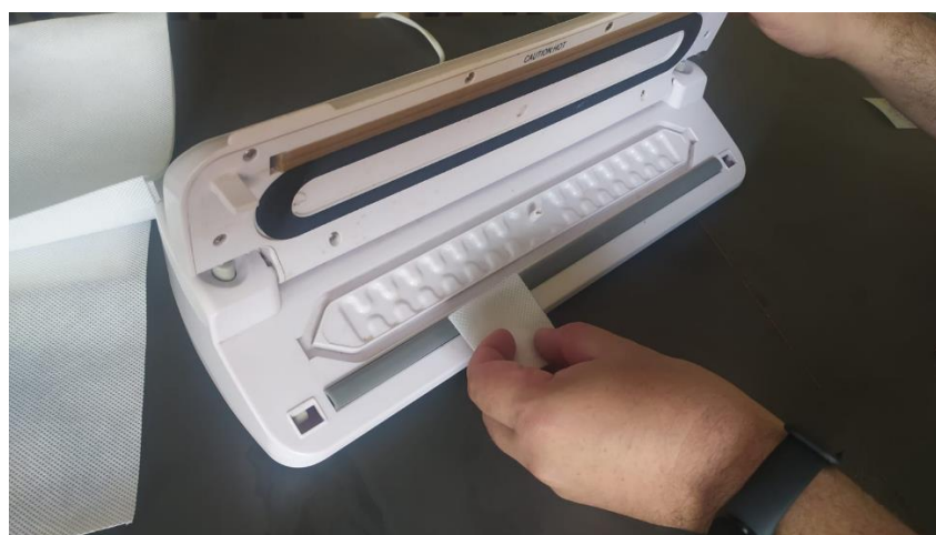
Figura 24 – Máquina seladora para selagem dos saquinhos. São necessários testes prévios para ajuste da temperatura.
