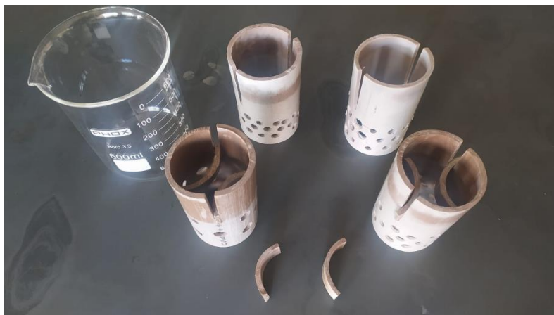
Figura 25 – Materiais alternativos confeccionados a partir de tubo de PVC para alocação dos saquinhos de TNT com amostras
