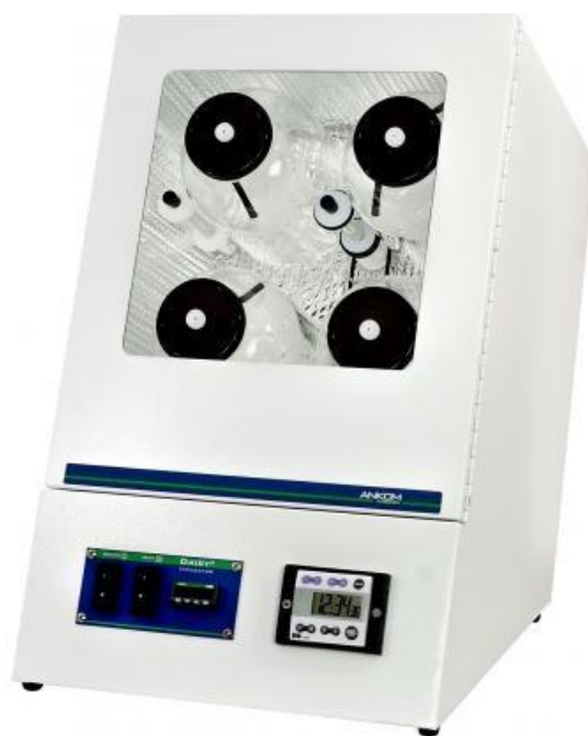
Figura 39 – Sistema Dayse Incubator da Ankon, utilizado para ensaio de digestibilidade in vitro .
