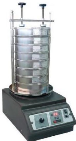
Figura 50 – Equipamento vibrador utilizado para determinação da granulometria, montado a partir de peneiras de diferentes malhas. Pode ser chamado também de agitador magnético com peneiras
