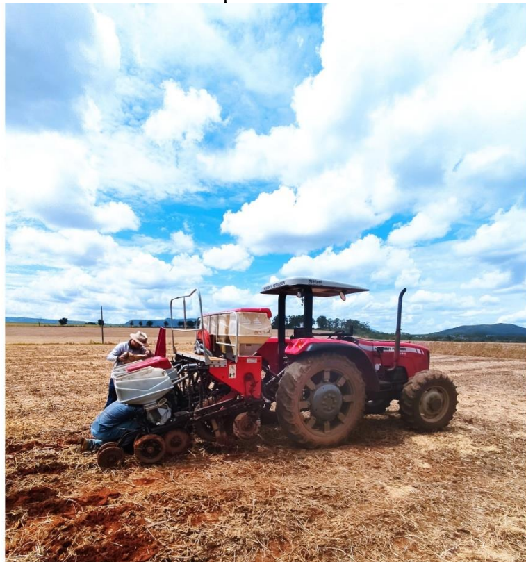
Figura 1 - Semeadora-adubadora realizando distribuição das sementes e dos fertilizantes, no município de Piumhi-MG
