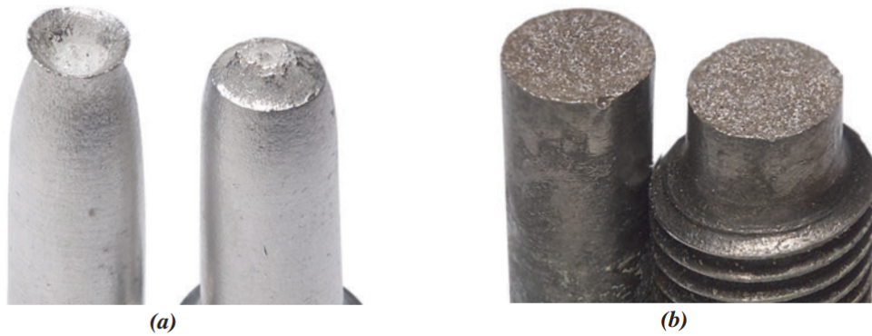
Figura 10 – Fratura dúctil (a) e fratura frágil (b).
