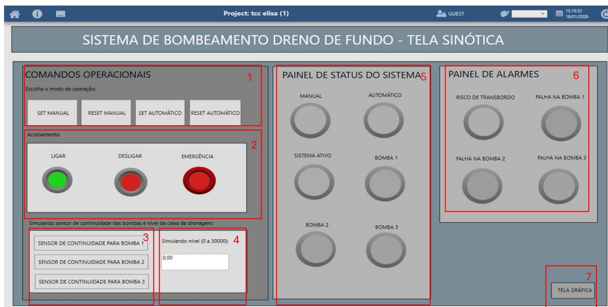
Figura 20 – Tela principal do sistema supervisorio.
