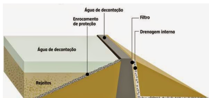
Figura 1 – Ilustração de uma barragem de rejeito
