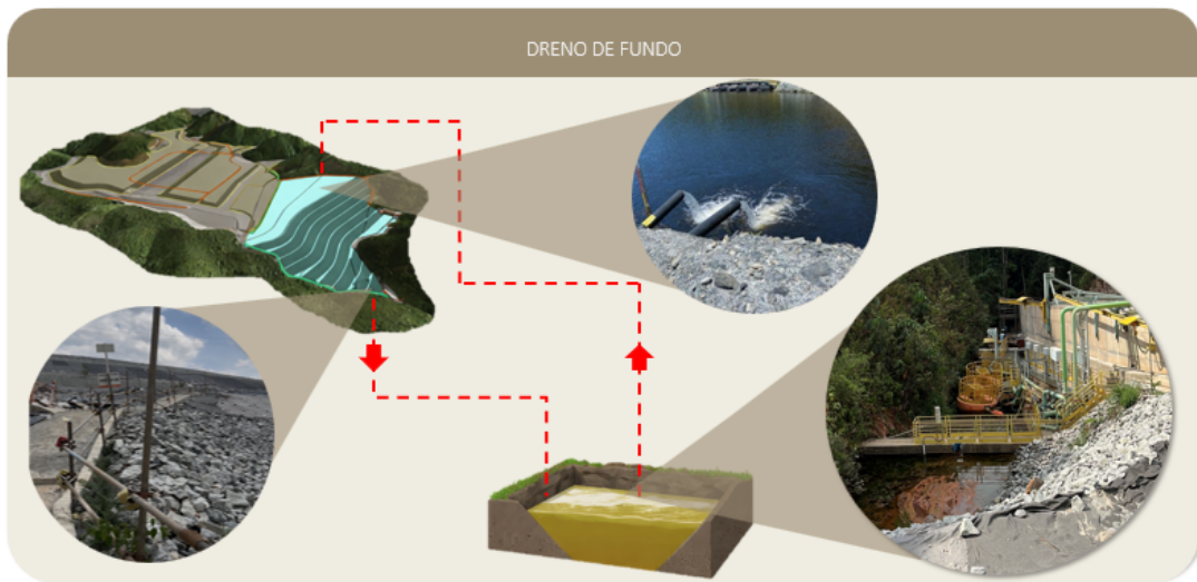
Figura 13 – Dreno de fundo de uma barragem de rejeitos de mineração de ouro.
