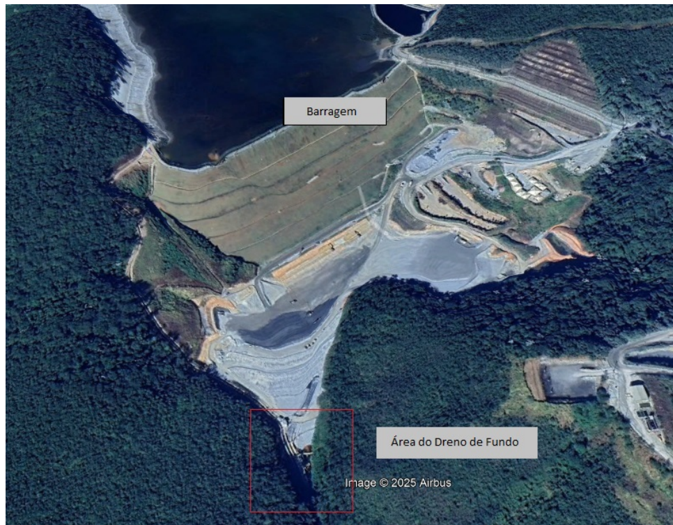
Figura 4 – Localização do sistema de dreno de fundo em relação à barragem de rejeitos
