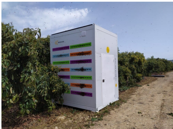
Figura 3: Colmeia robótica que vem com robô apicultor que auxilia no cuidado com as abelhas.
