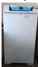
Figura 23: Estufa utilizada para secagem dos filmes.
