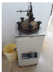
Figura 21: Autoclave utilizada para o aquecimento da solução filmogênica.
