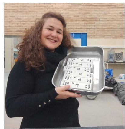
Figura 28 - Desmoldagem dos provetes após 96 horas.
