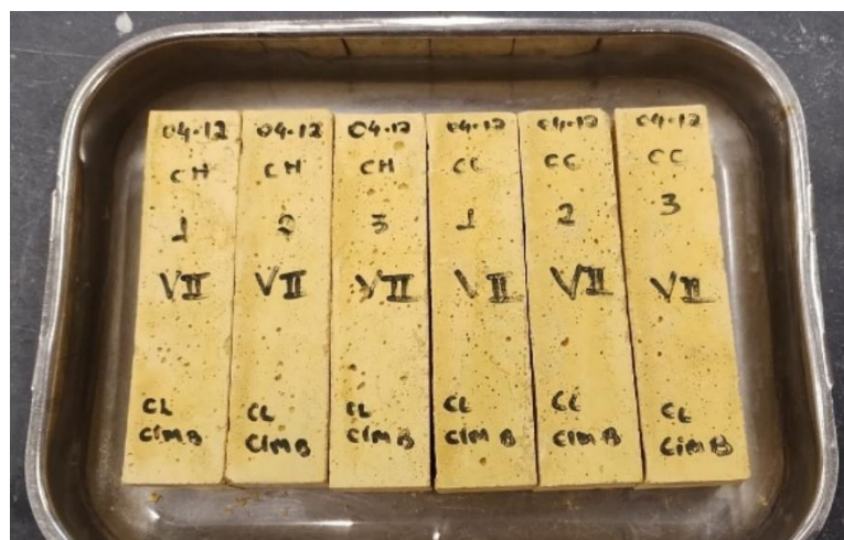
Figura 40 - Argamassa VII: coloração inicial.
