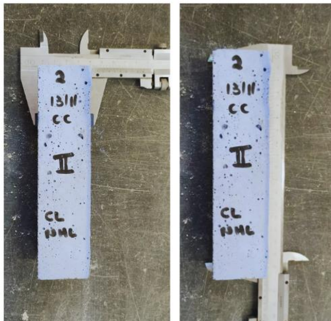
Figura 31 - Medição das dimensões longitudinais e transversais com paquímetro.
