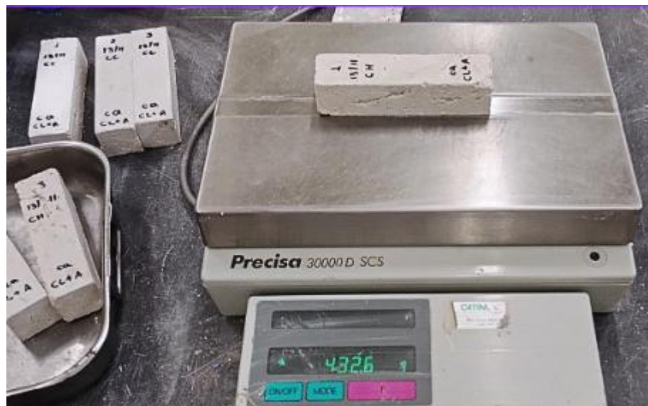
Figura 30 - Pesagem dos provetes em balança digital após a desmoldagem.
