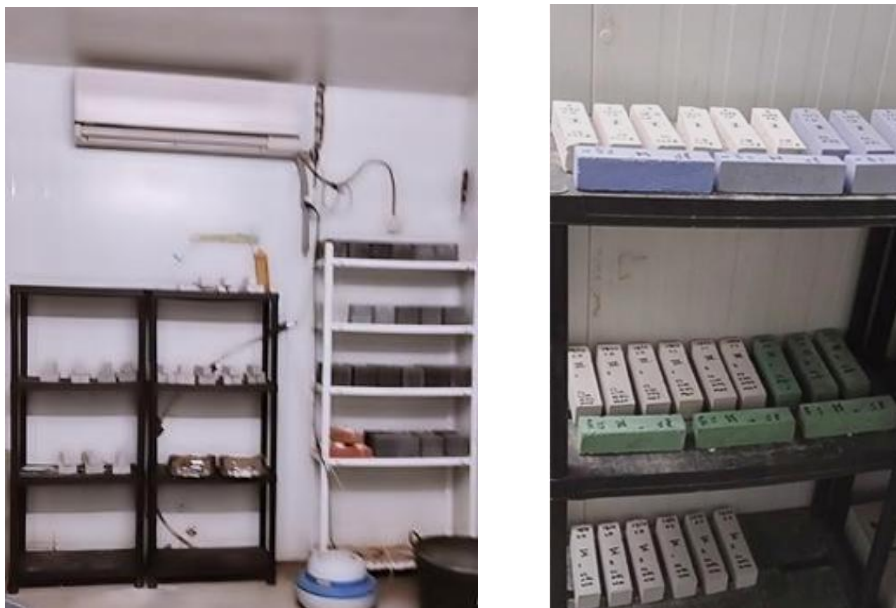
Figura 32 - Provetes acondicionados na câmara úmida.
