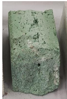
Figura 39 - Argamassa IV: seção transversal após rompimento, evidenciando a permanência do pigmento verde no interior.
