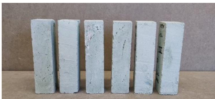
Figura 38 - Argamassa IV: alteração cromática discreta após cura em câmara úmida.
