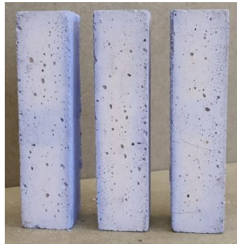
Figura 35 - Argamassa II: alteração cromática na superfície em contato com a prateleira após cura em câmara úmida.
