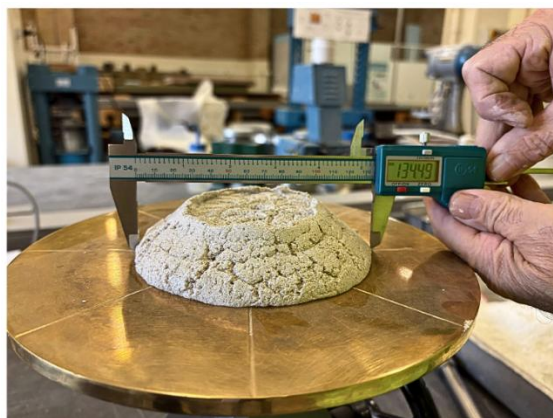
Figura 24 - Medição do diâmetro de espalhamento com paquímetro digital.
