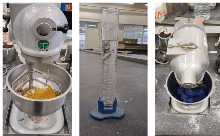
Figura 22 - Etapas de produção das argamassas: mistura dos materiais secos em misturadora mecânica, medição da água de amassadura em proveta graduada e homogeneização da mistura.
