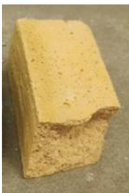
Figura 42 - Argamassa VII: seção transversal após rompimento, evidenciando a preservação do amarelo intenso no interior.
