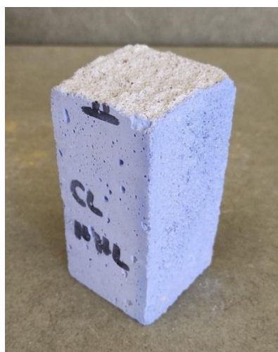
Figura 36 - Argamassa II: seção transversal após rompimento, evidenciando a migração do pigmento para as camadas superficiais.
