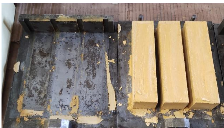
Figura 28 - Desmoldagem dos provetes após 96 horas.
