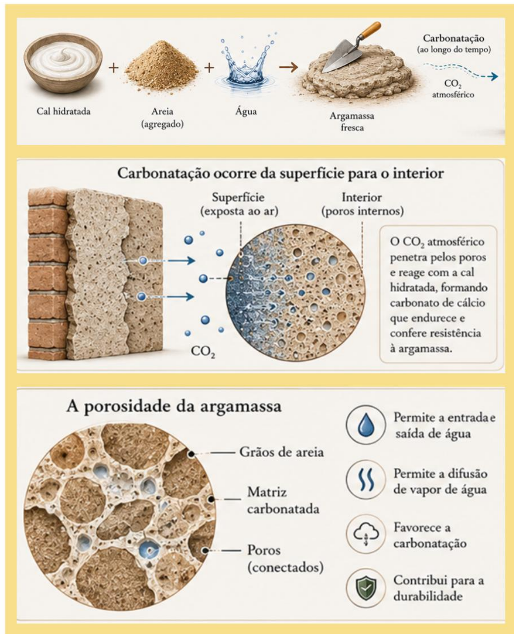
Figura 11 - Composição e processo de endurecimento de uma argamassa tradicional.
