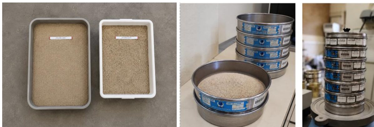
Figura 16 - Areia silicosa rolada durante o processo de caracterização granulométrica.
