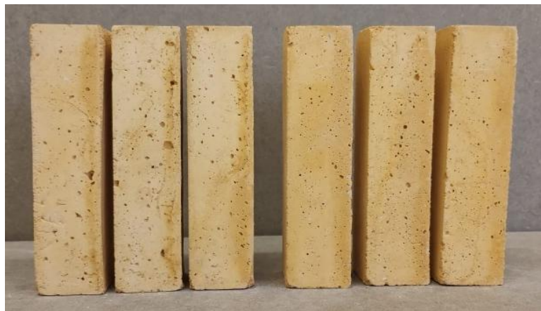
Figura 41 - Argamassa VII: desbotamento superficial após cura em câmara úmida.
