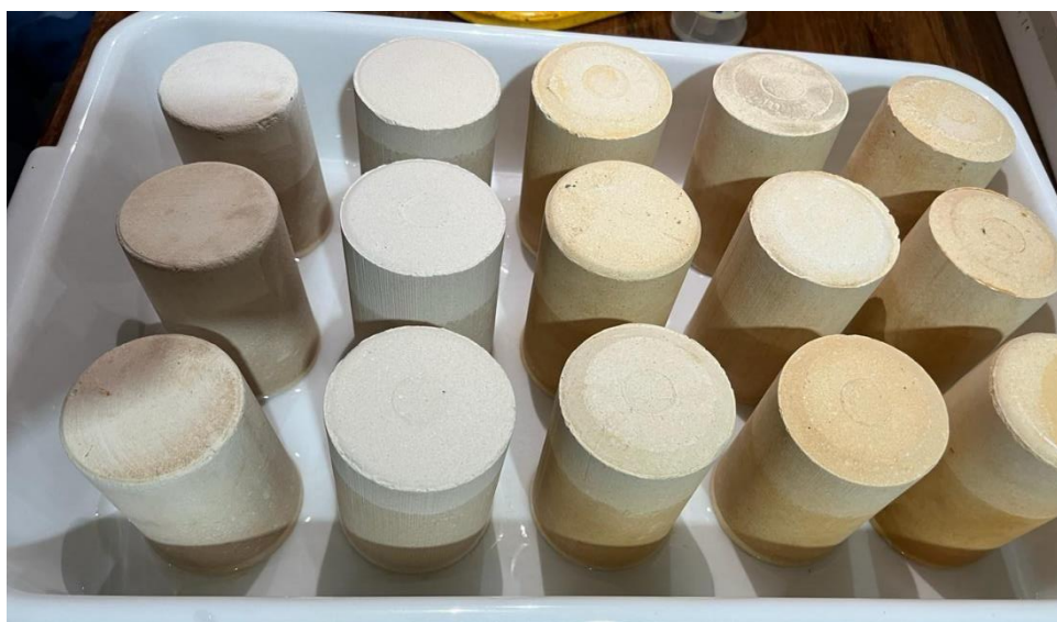
Figura 2: Velas de filtro em bandeja plástica com água.
