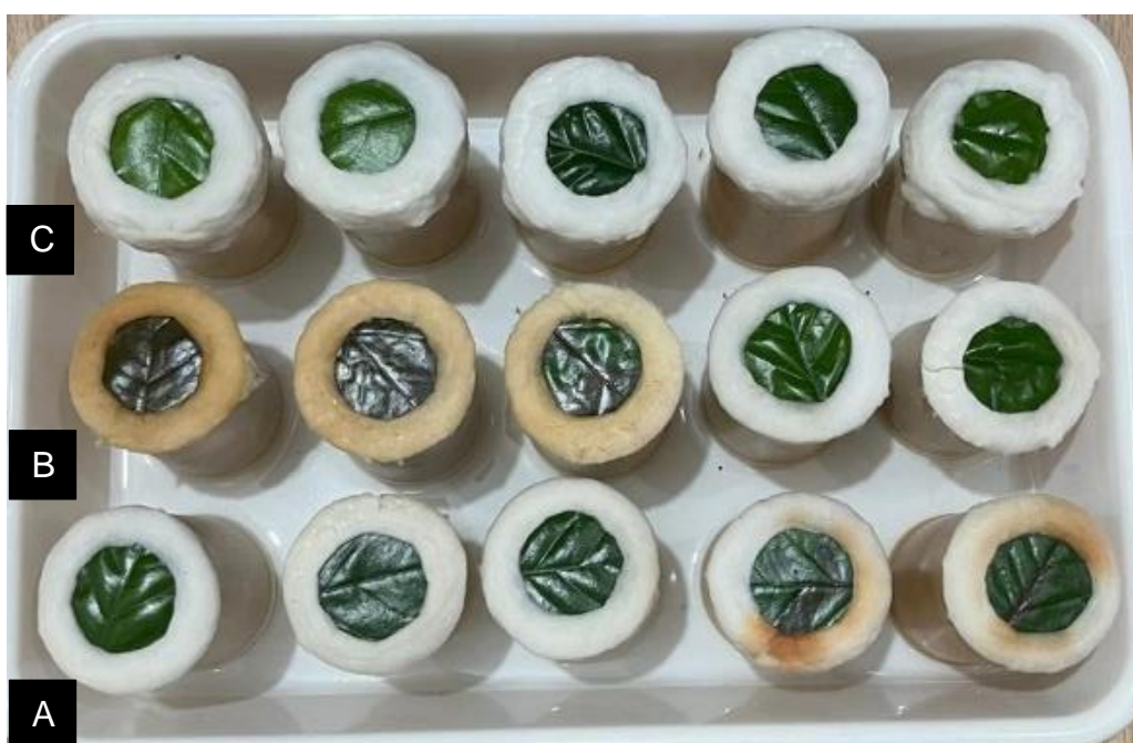
Figura 7- Discos foliares de cafeeiro sobrepostos em velas de filtro com diferentes produtos entre a folha e a vela. A. papel toalha; B. algodão; C, espuma.
