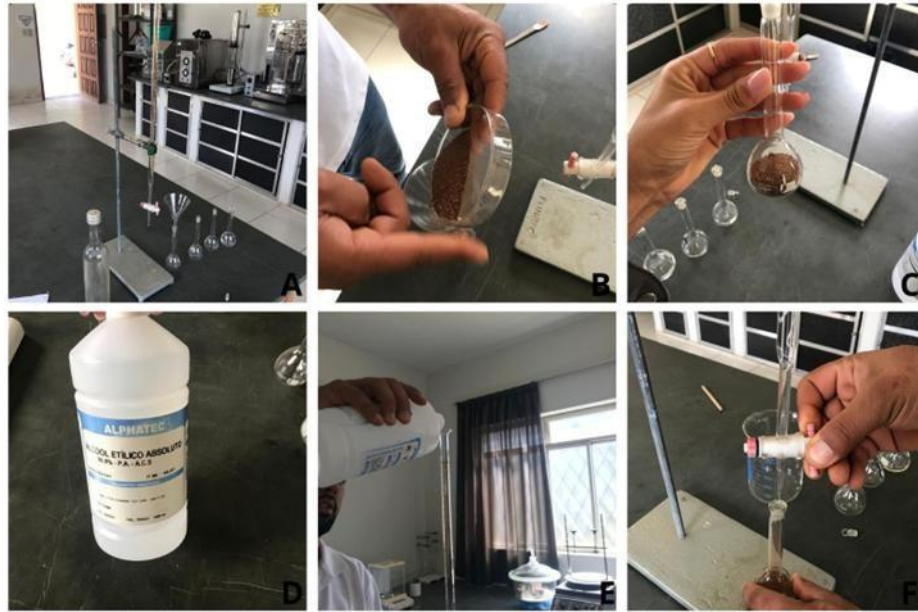
(A) Equipamentos; (B) Adição da amostra no funil; (C) Balão volumétrico com amostra; (D) Álcool etílico (E) Adição do álcool; (F) Válvula de controle Fonte: Elaborado pela autora, 2025.
