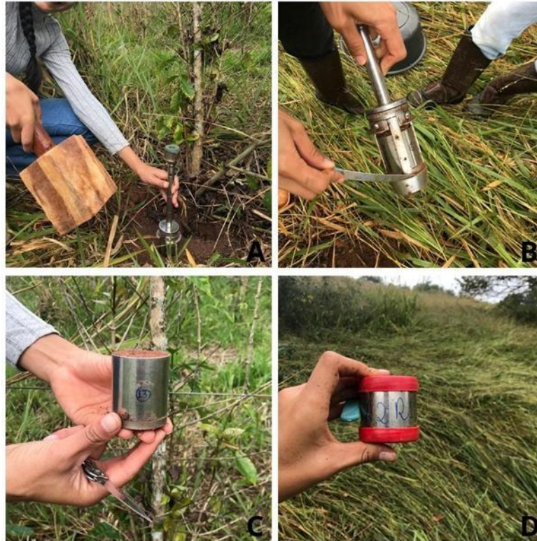
Figura 6 - Procedimento de coleta das amostras de solo
