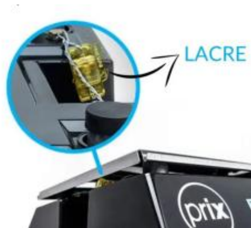
Figura 11 - Balança lacrada após reparo
