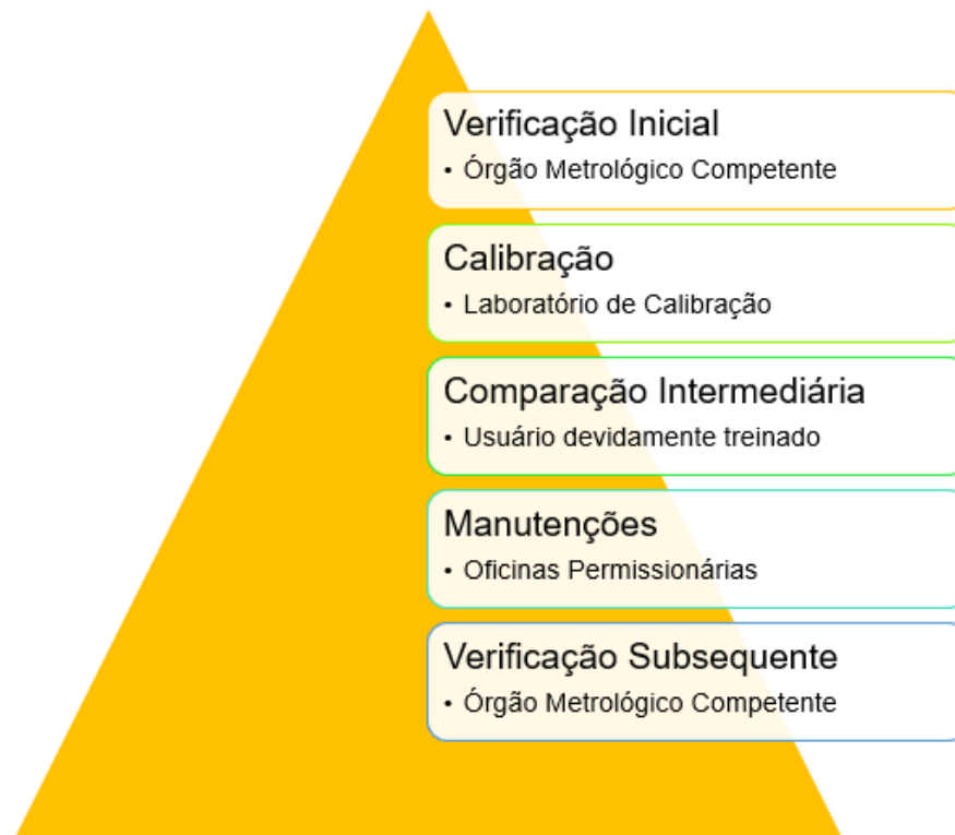
Figura 1 - Processos básicos para confiabilidade em sistemas de pesagens
