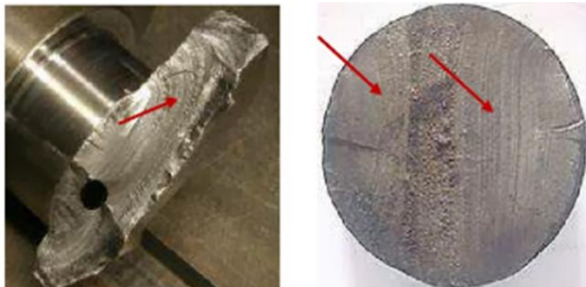
Figura 8 - Marcas de praia sinalizando a fratura por fadiga.
