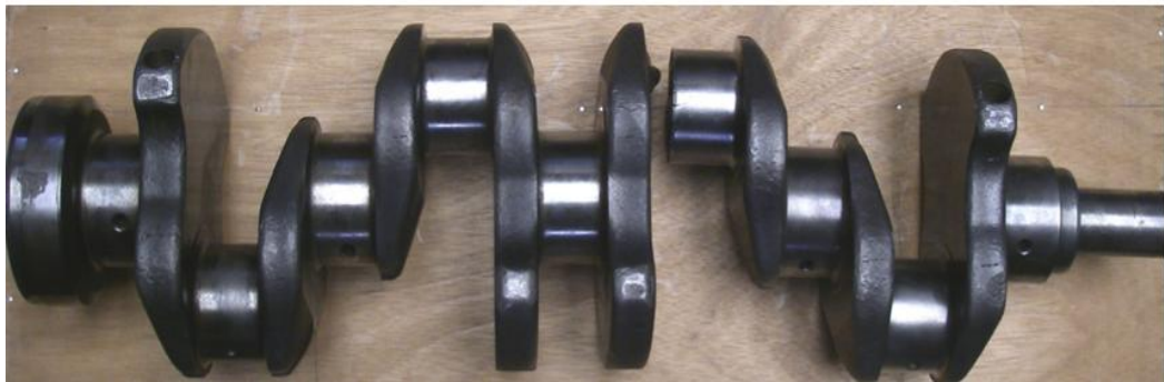
Figura 21: Local de falha do virabrequim – Estudo Fonte et al. 2013.
