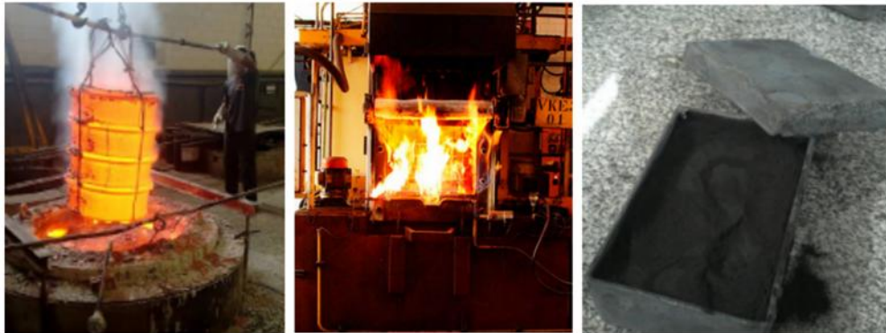
Figura 17 - Representação ordenada dos meios e estruturas empregados para a realização da cementação líquida, gasosa e sólida.
