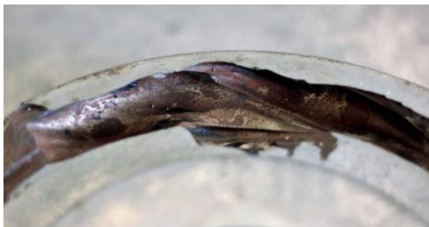
Figura 12 - Demonstração do desgaste erosivo.
