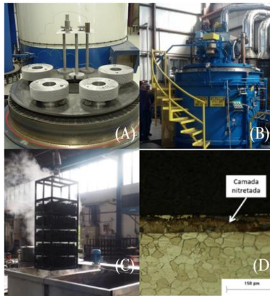
Figura 16 - Ilustração dos diferentes métodos de nitretação e a modificação gerada na superfície do material.
