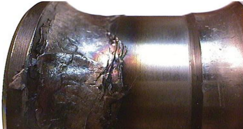
Figura 11 - Desgaste por adesão em componentes.
