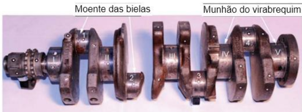
Figura 20: Visão do virabrequim após a falha – Estudo Witek et al., 2017.
