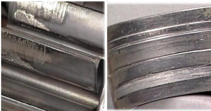
Figura 10 - Desgaste em peças de maquinário.
