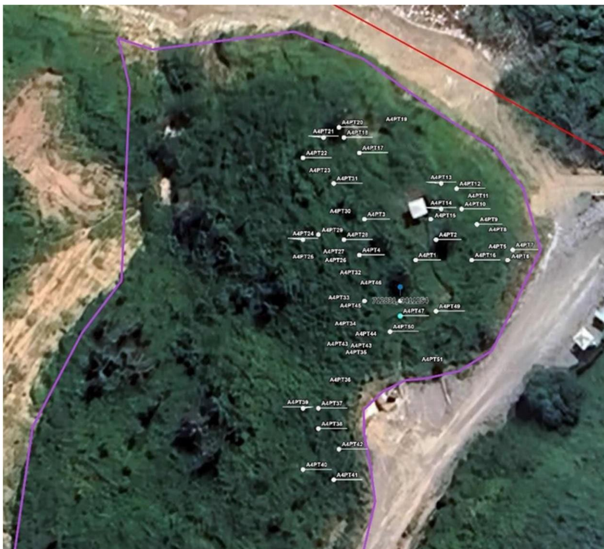
Figura 46 – Mapa com refinamento da delimitação da área 04 e distribuição dos poços-teste
