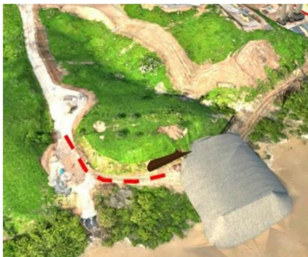
Figura 31 – 1ª etapa referente ao alargamento de acesso para a rampa de embarque
