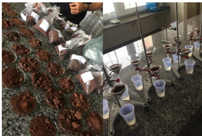
Figura 4: Processo de determinação da Capacidade de Campo (CC) em laboratório.
