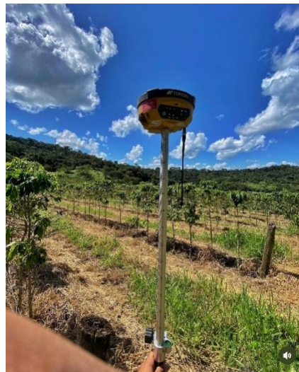
Figura 5: Levantamento topográfico com receptor GNSS RTK.
