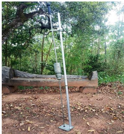
Figura 3: Penetrômetro de impacto utilizado para determinação da resistência do solo.
