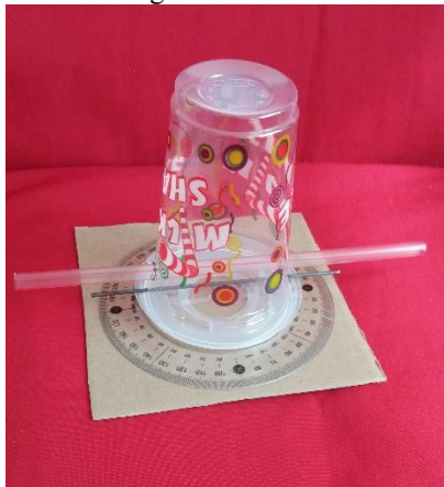
Figura 28 - Etapa 6 da montagem do Teodolito Artesanal de baixo custo
