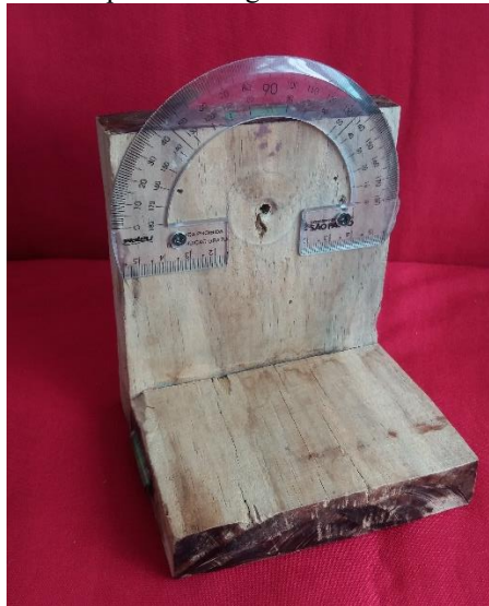
Figura 20 - Etapa 2- montagem do Teodolito Artesanal.
