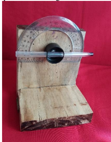
Figura 22 - Etapas 5 e 6- montagem do Teodolito Artesanal.
