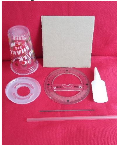
Figura 24 - Materiais para montagem do Teodolito Artesanal de baixo custo.
