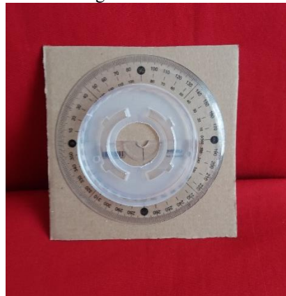
Figura 26 - Etapa 4 da montagem do Teodolito Artesanal de baixo custo.
