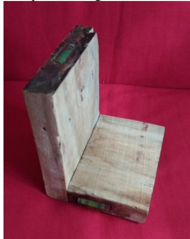
Figura 19 - Etapa 1- montagem do Teodolito Artesanal.
