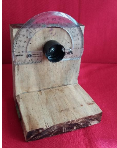
Figura 21 - Etapas 3 e 4- montagem do Teodolito Artesanal.
