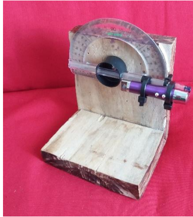
Figura 23 - Etapa 7 - montagem do Teodolito Artesanal.
