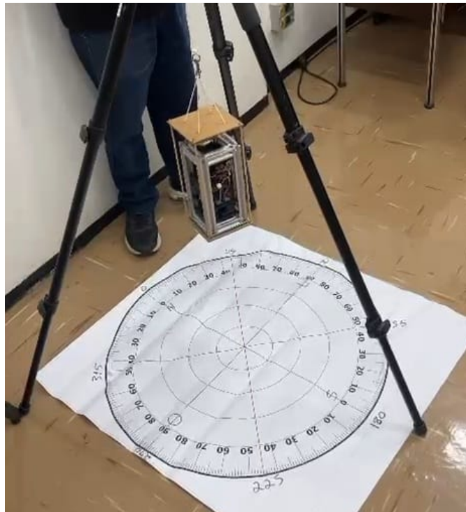
Figura 25 – Registro durante a realização do teste do sistema ADCS no INPE
