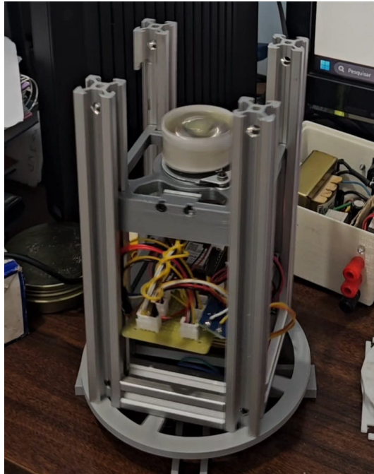
Figura 7 – Teste de bancada para modelagem do atuador e sistema de controle
