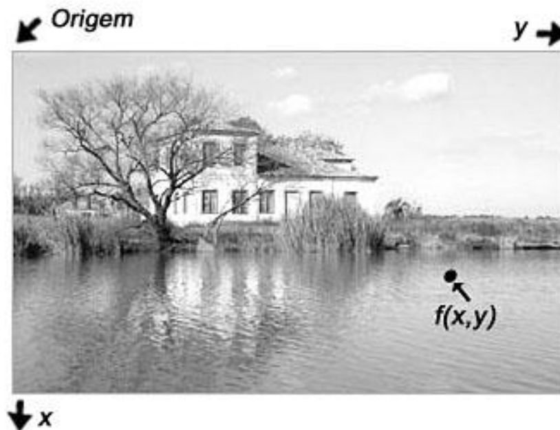
Figura 7 – Convenção dos eixos para representação de imagens digitais.
