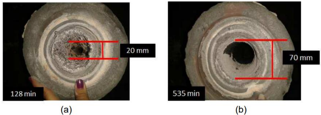
Figura 23 – Tubo submerso apresentando (a) obstrução prematura (b) deposição de alumina sem restrição do fluxo de aço.
