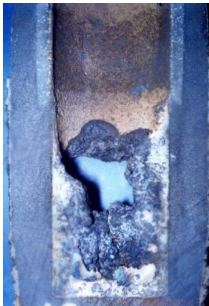
Figura 12 – Clogging de alumina em válvula submersa.
