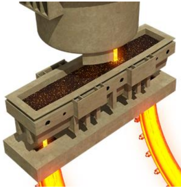
Figura 3 – Desenho de distribuidor de lingotamento contínuo
