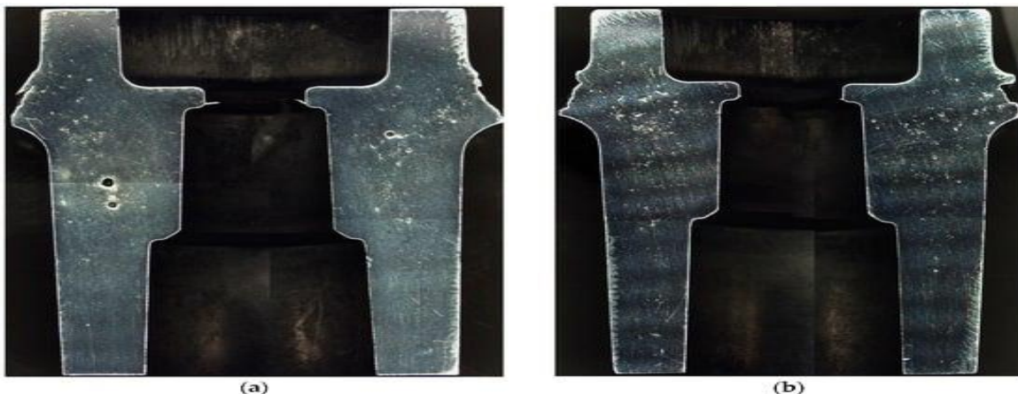
Figura 5 – Porosidade em peças moldadas em refrigeração convencional (a) e conformada (b)
