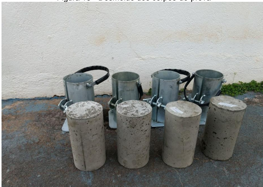
Figura 15 - Desmolde dos corpos-de-prova
