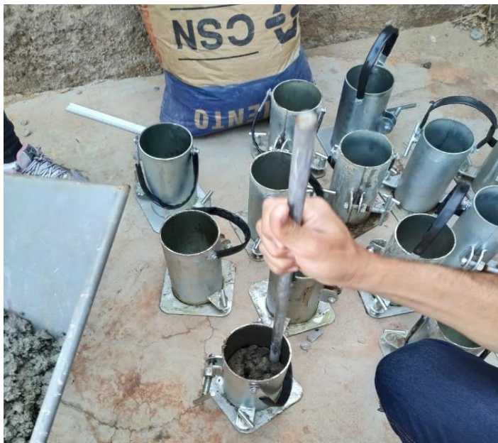
Figura 14 - Adensamento camadas corpos-de-prova
