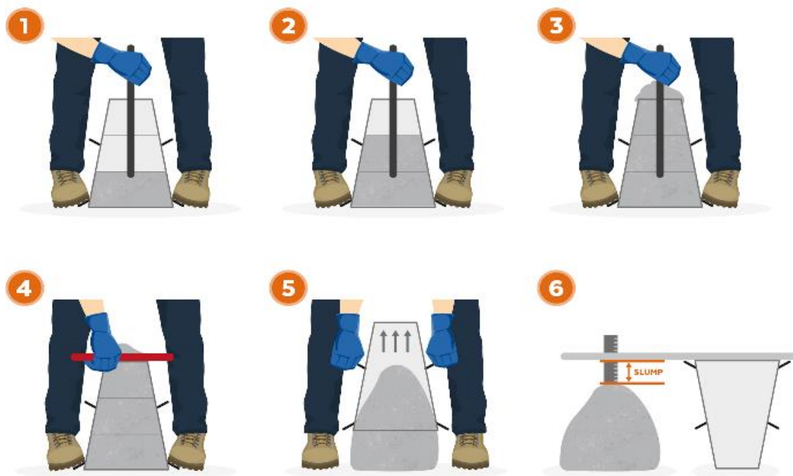
Figura 4 - Ensaio de abatimento de cone
