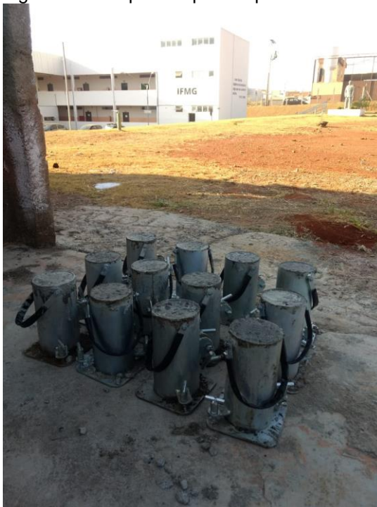
Figura 16 - Corpos-de-prova após cura inicial.
