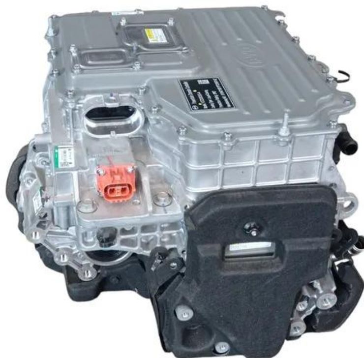
Figura 13 - Motor elétrico BYD Dolphin GS 180ev 2024
