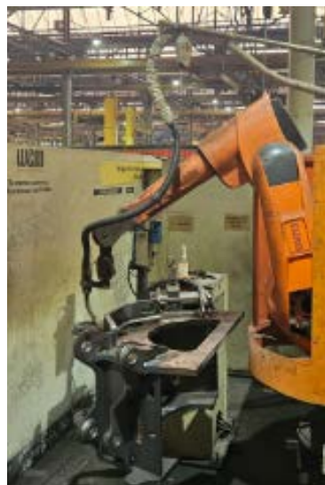
Figura 13 – Robô de Solda Quirox QRC 350
