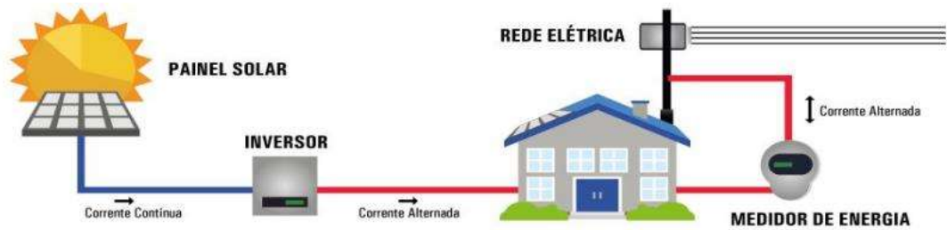
Figura 6 – Sistema Fotovoltaico On-Grid .
