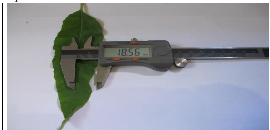
FOTO 23 - Medida da largura direita utilizando um paquímetro digital DigimeSS, precisão 0,1mm, na maior largura da folha e a partir da nervura central.
