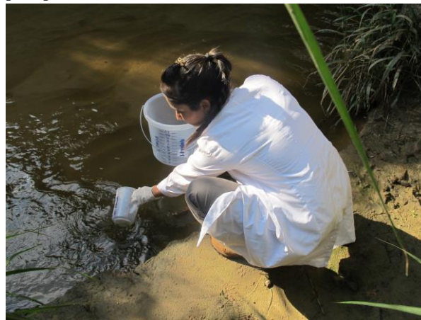
FOTO 17 - Coleta indireta de amostras no Ponto 02, para posterior acondicionamento.
