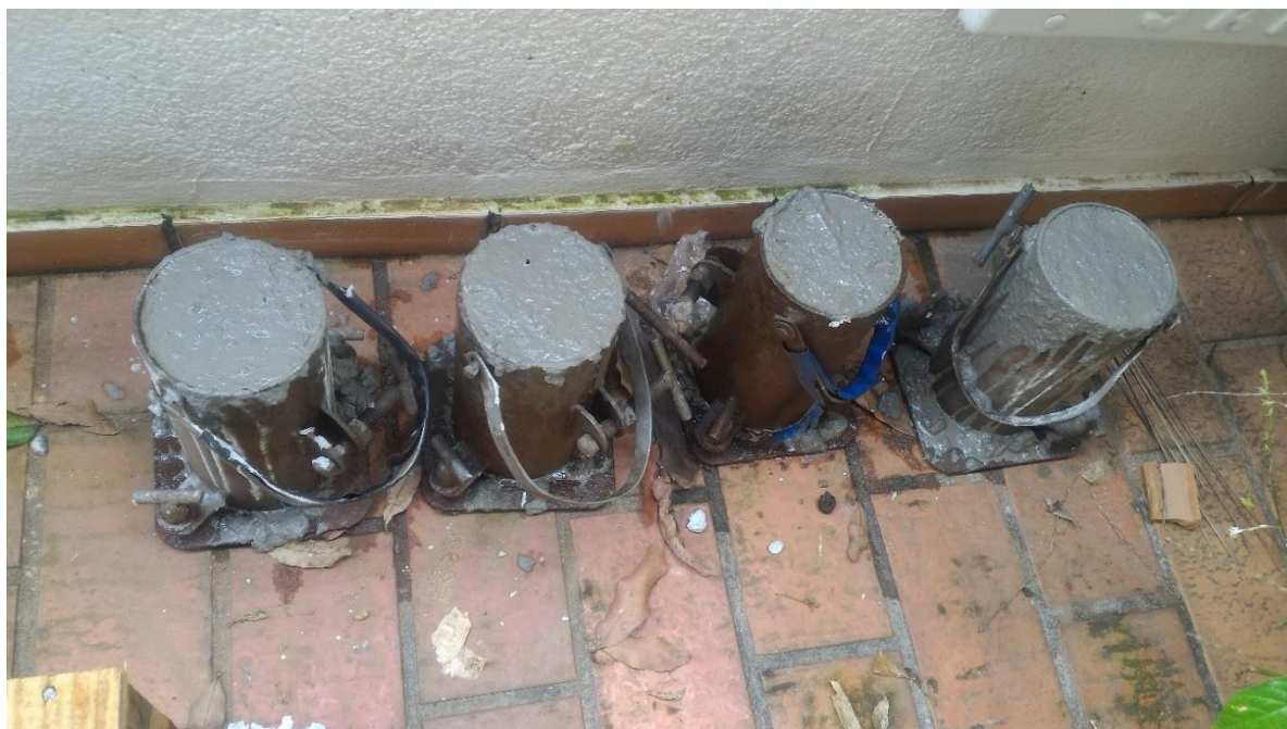
Figura 8 - Corpos de prova moldados na obra.
