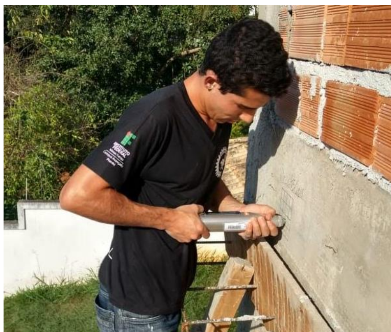
Figura 11 - Realização do ensaio de esclerometria.
