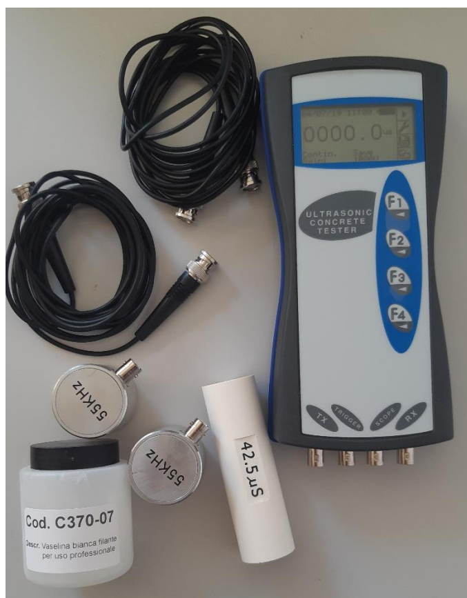
Figura 13 - Instrumento ultrassônico utilizado no estudo.
