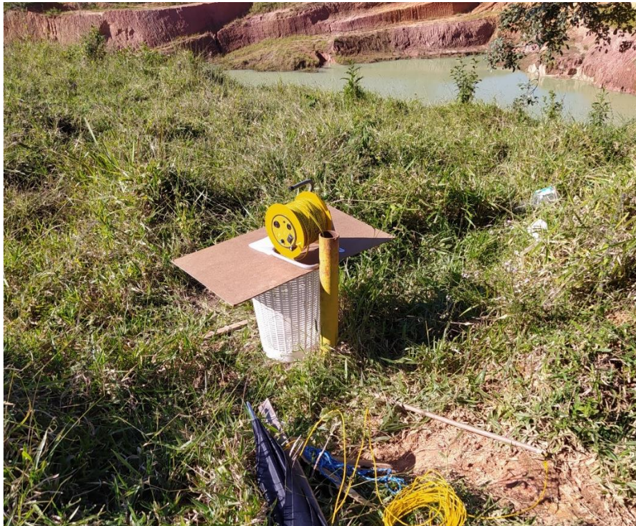
Figura 9 - Piezômetro instalado na microbacia de estudo e utilizado para realização dos ensaios de slugtest e bailtest .
