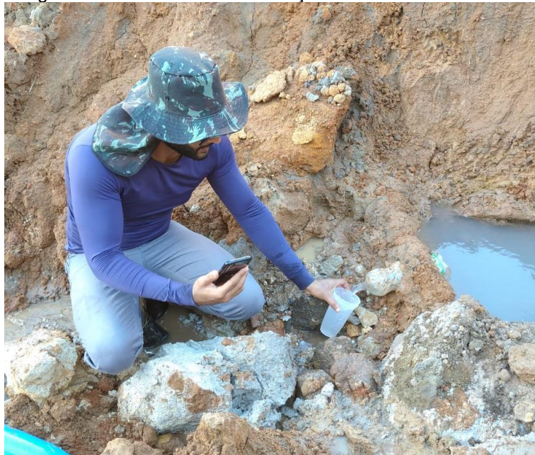
Figura 8 - Procedimento de medição de vazão da nascente.
