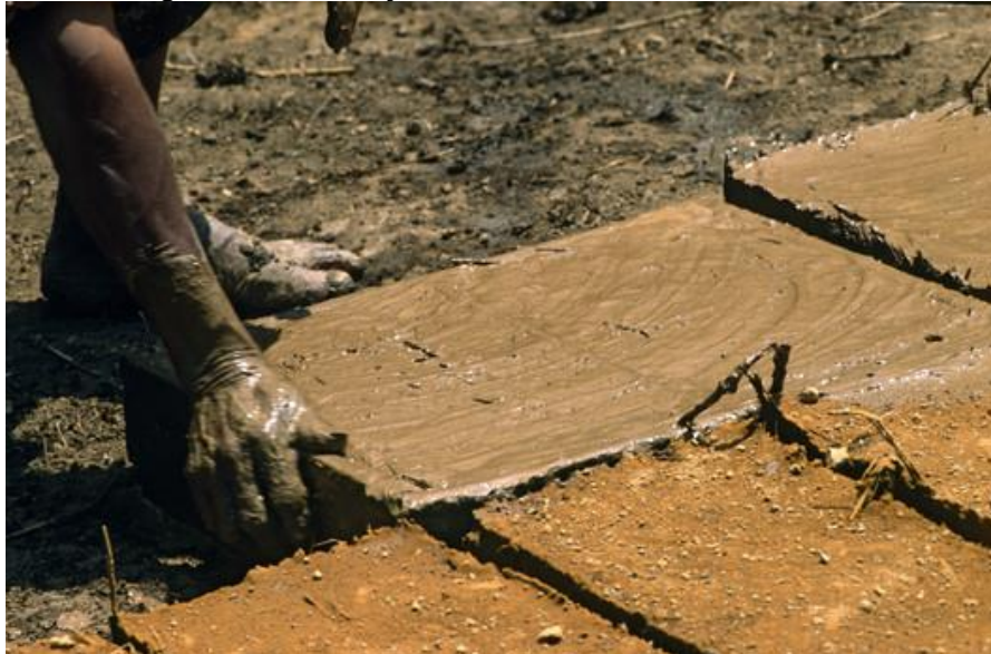
Figura 4 – Formação artesanal de blocos de adobe
