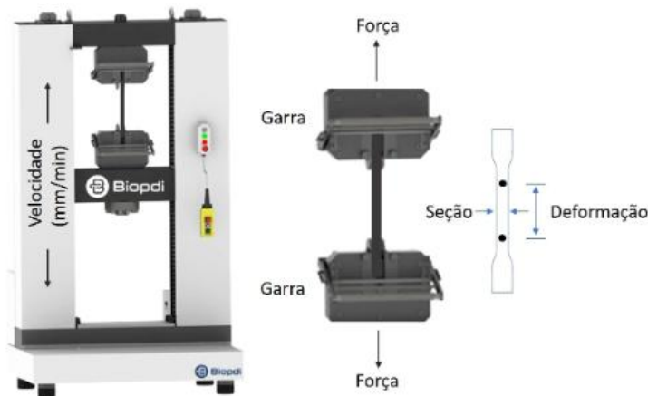
Figura 8 – Máquina Universal de Ensaio de Tração – Extensômetro
