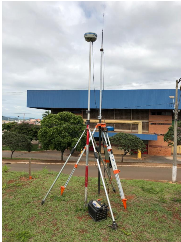
Figura 8 – Base, rádio de transmissão, bateria.
